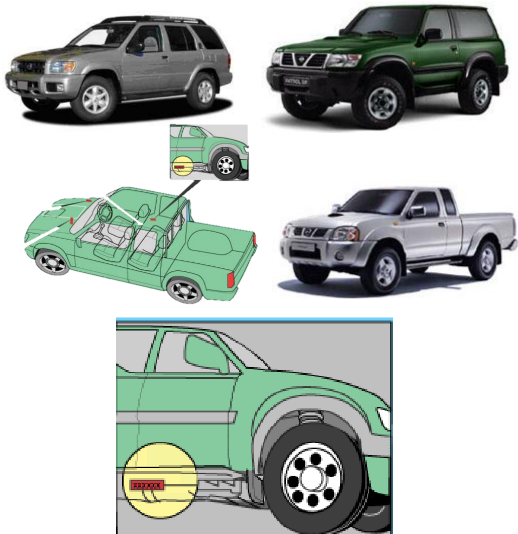
Figura 74. Identificación de chasis para vehículos tipo bastidor
