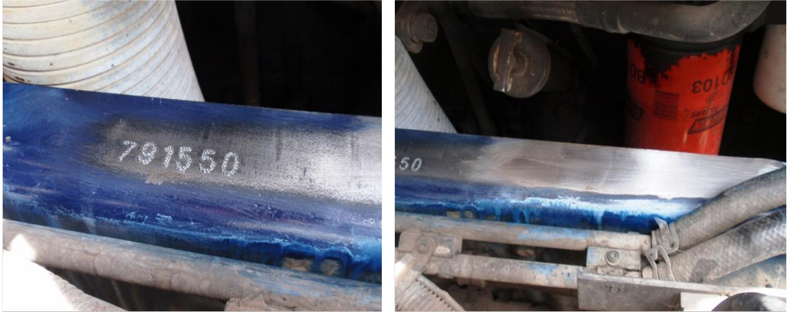
Figura 101. Grabado de una identificación falsa y esmerilado del área donde va la identificación del chasis original
