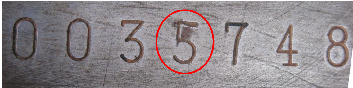
Figura 104. Carácter esmerilado y luego sobretroquelado
