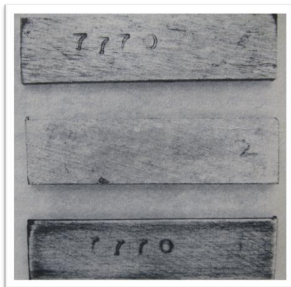
Figura 89. Proceso de recuperación de números estampados
