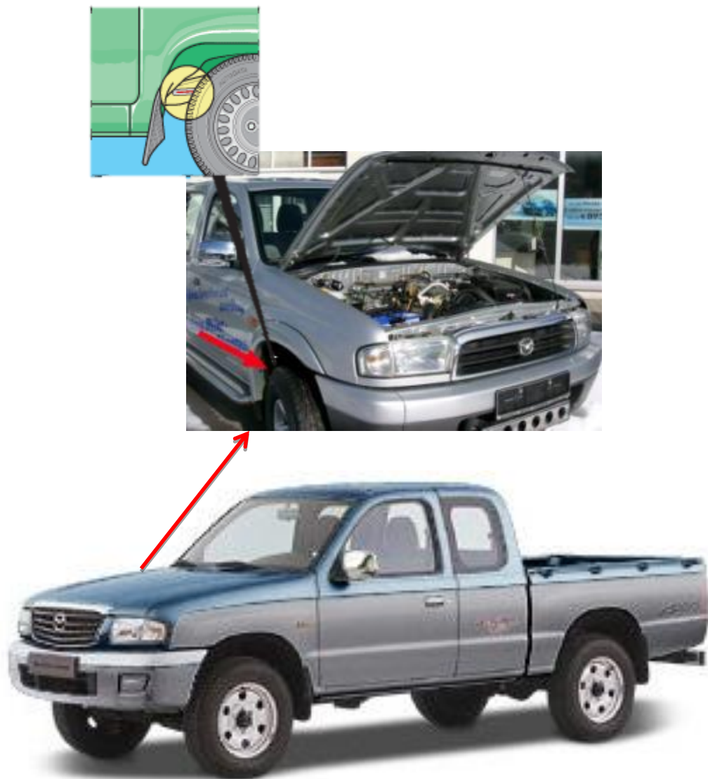
Figura 68. Identificación de chasis para vehículos tipo picop
