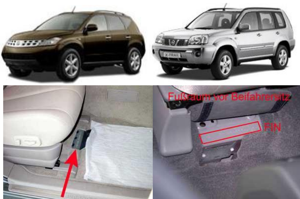
Figura 56. Identificación de chasis para camionetas tipo monocasco
