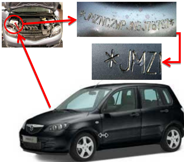
Figura 47. Identificación de chasis en amortiguador delantero derecho
