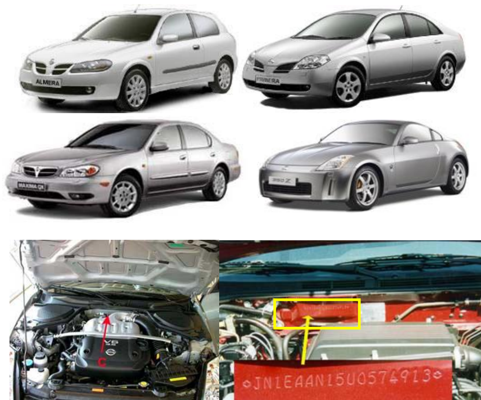
Figura 72. Identificación de chasis para vehículo tipo monocasco o autoportante
