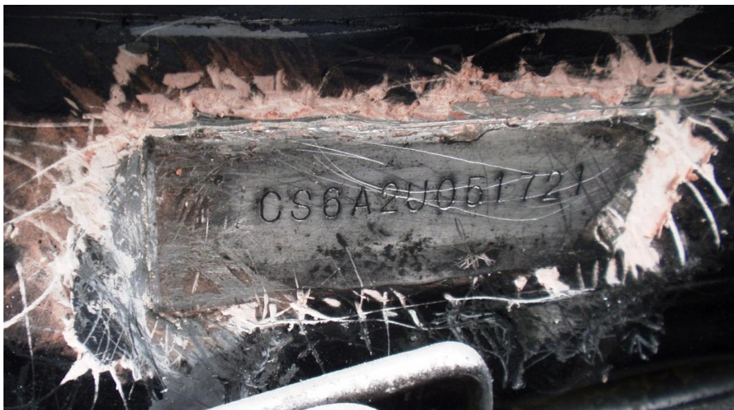
Figura 109. Pieza metálica con una identificación falsa que ha sido injertada en el área donde va ubicada la original
