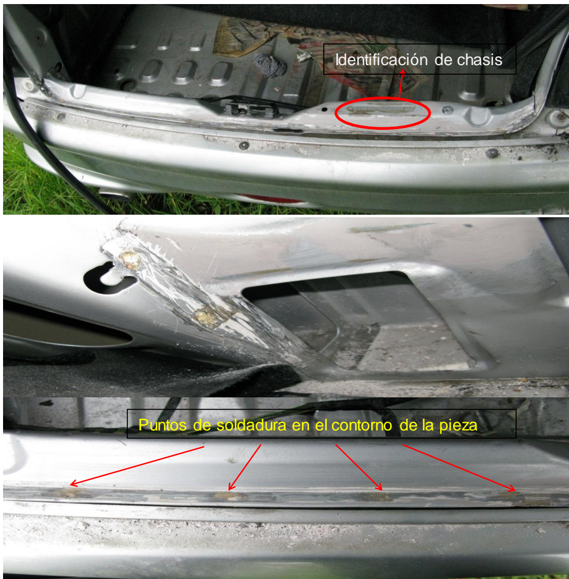
Figura 111. Injerto de toda la pieza donde va la identificación de chasis
