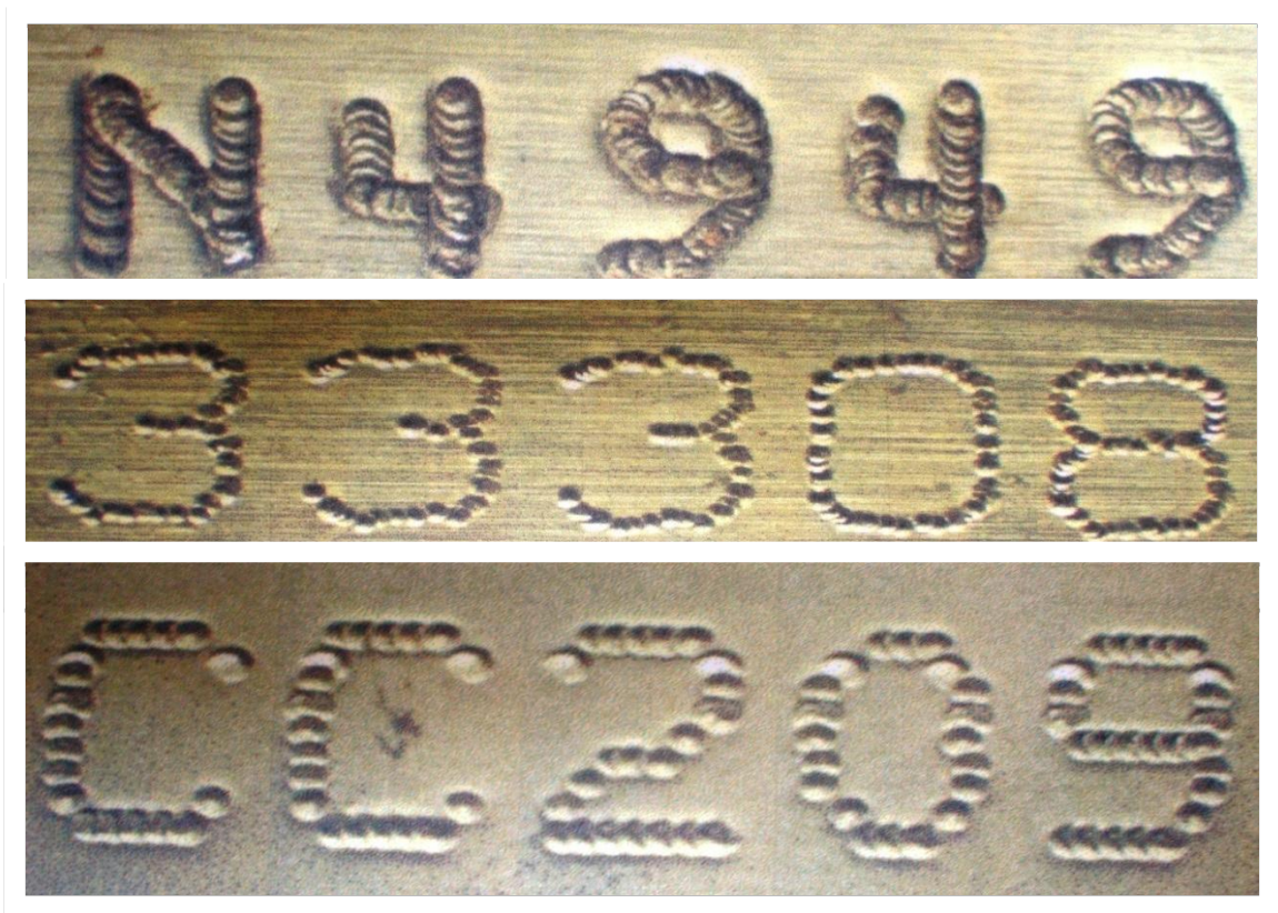
Figura 98. Grabado con pin y matriz de puntos
