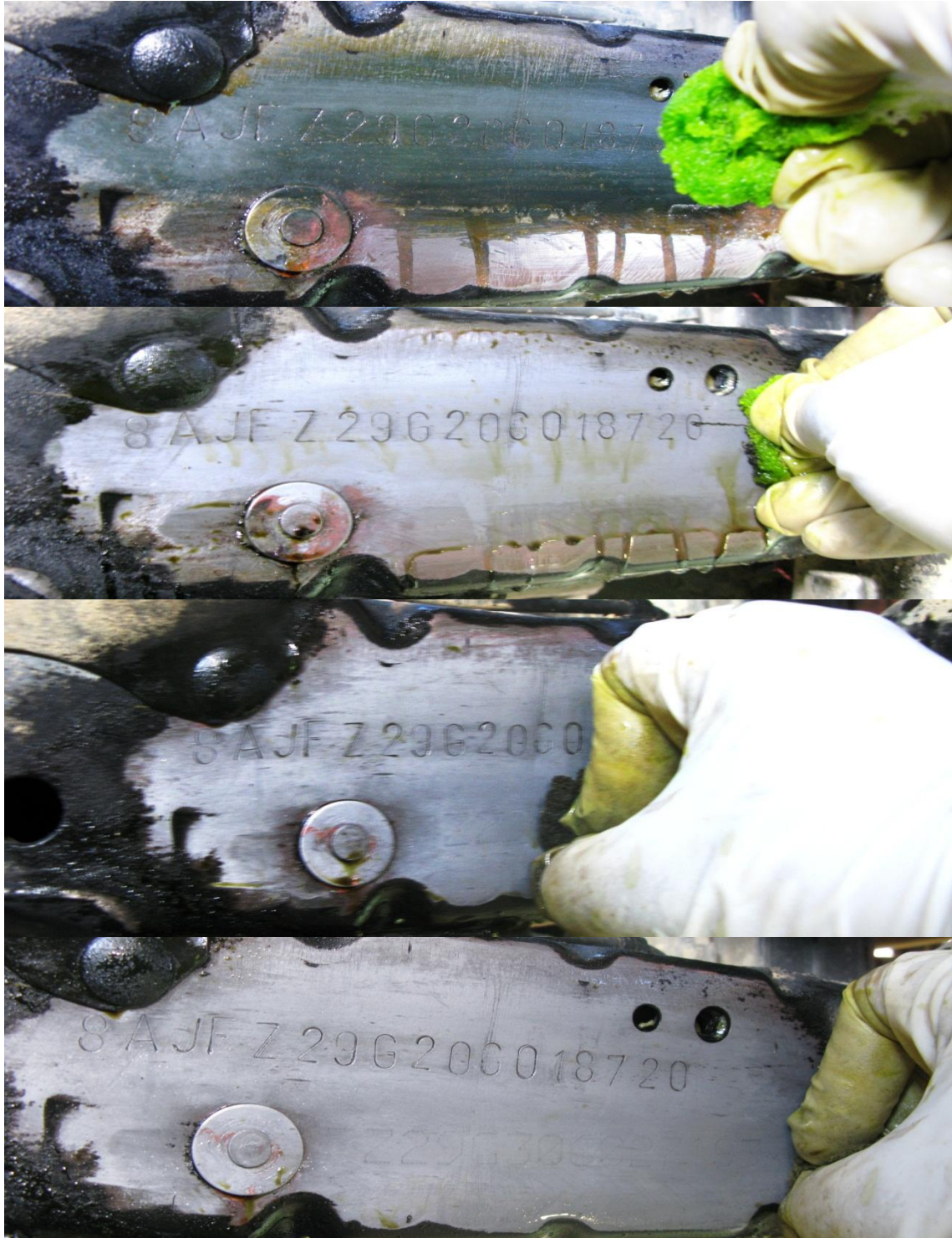
Figura 121. Aplicando FRY o reactivo
