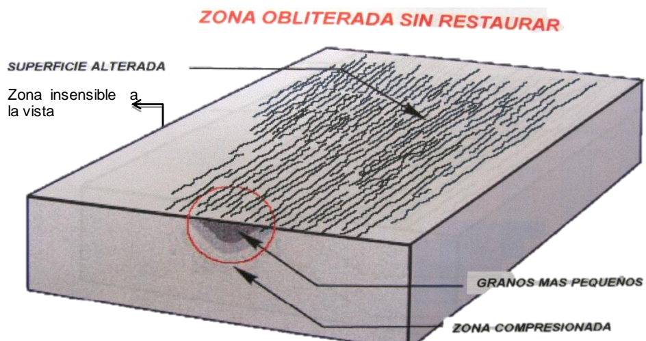
Figura 100. Caracter obliterado, zona insensible a la vista
