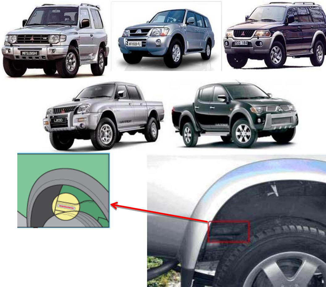
Figura 54. Identificación de chasis para vehículos tipo bastidor
