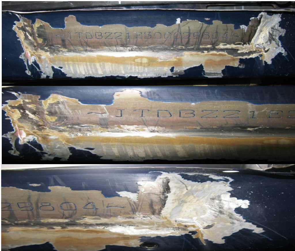
Figura 110. Injerto cubierto con masilla plástica y pintura
