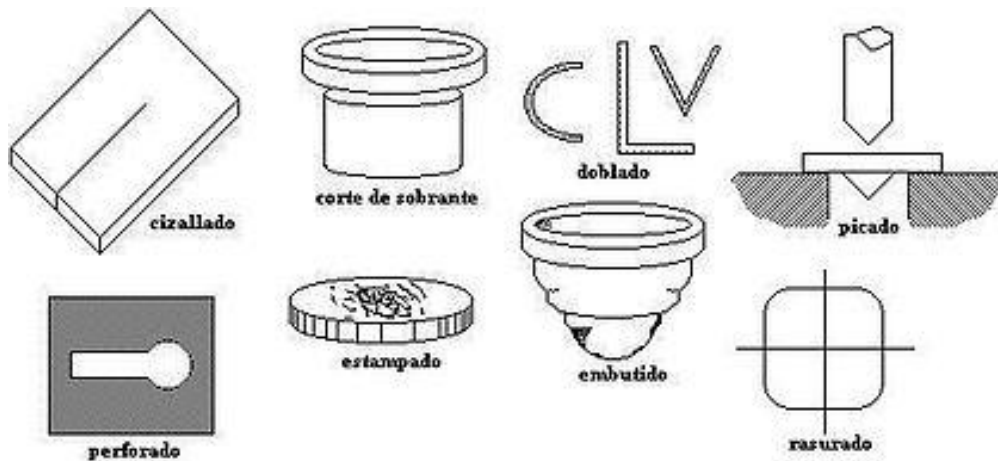
Figura 93. Operaciones del troquel
