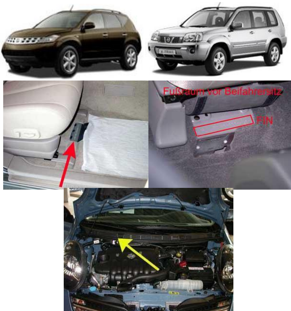
Figura 73. Identificación de chasis para camionetas tipo monocasco
