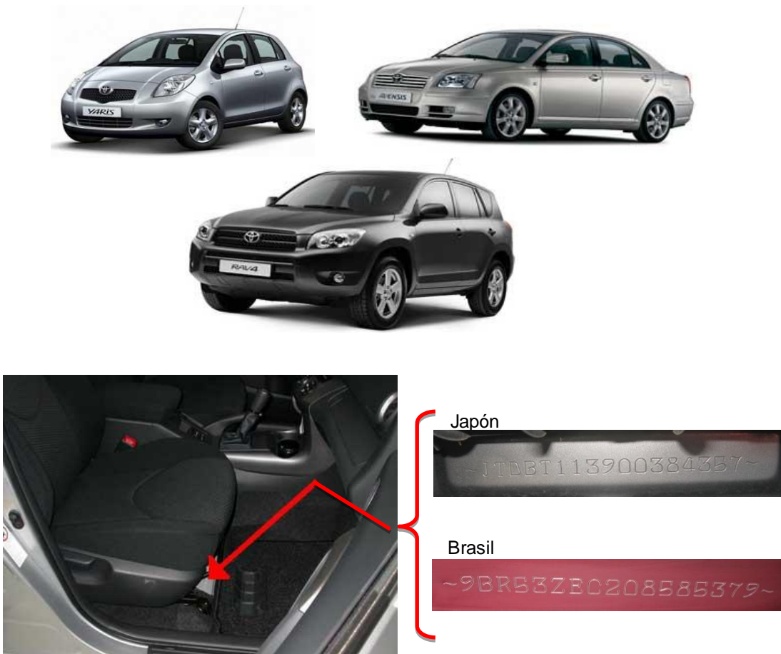
Figura 77. Identificación de chasis para vehículos tipo monocasco debajo de asiento de copiloto
