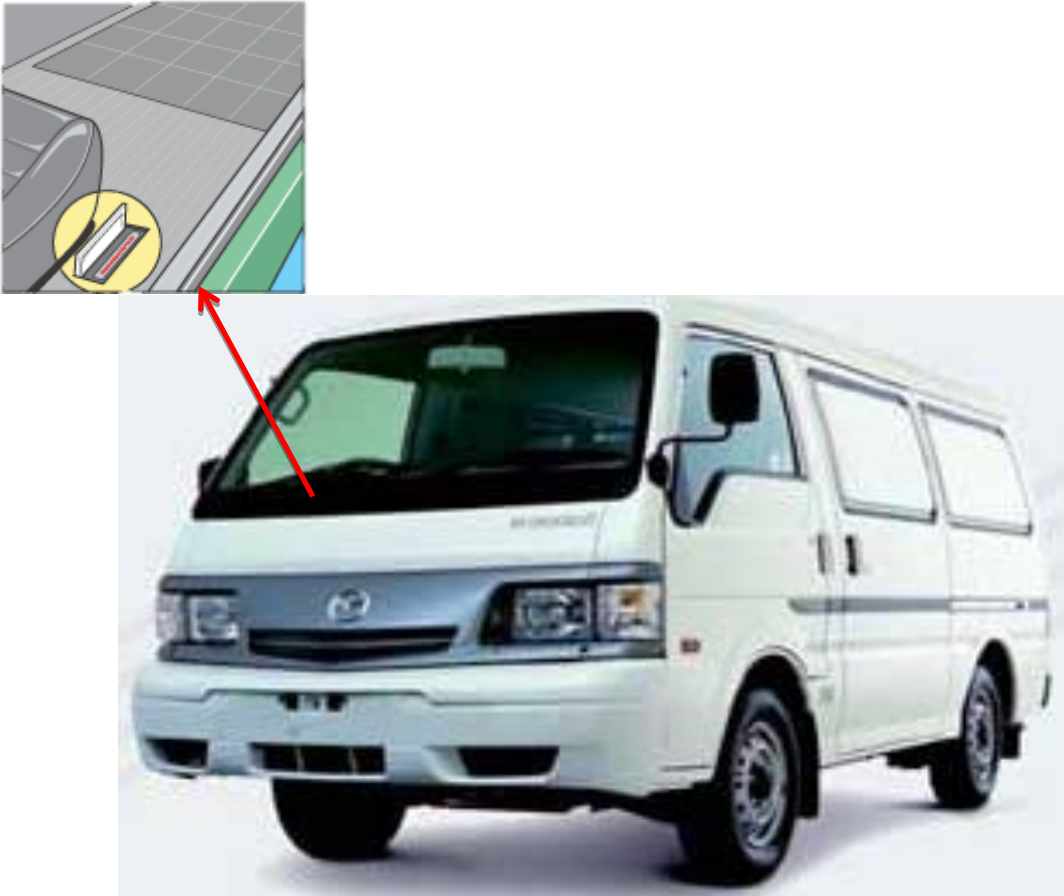
Figura 51. Identificación de chasis para vehículos tipo microbús o panel
