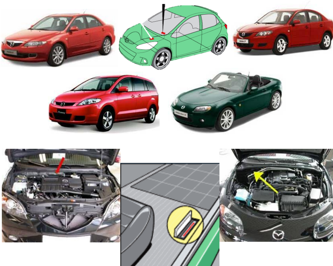
Figura 67. Identificación de chasis en vehículo tipo monocasco o autoportante
