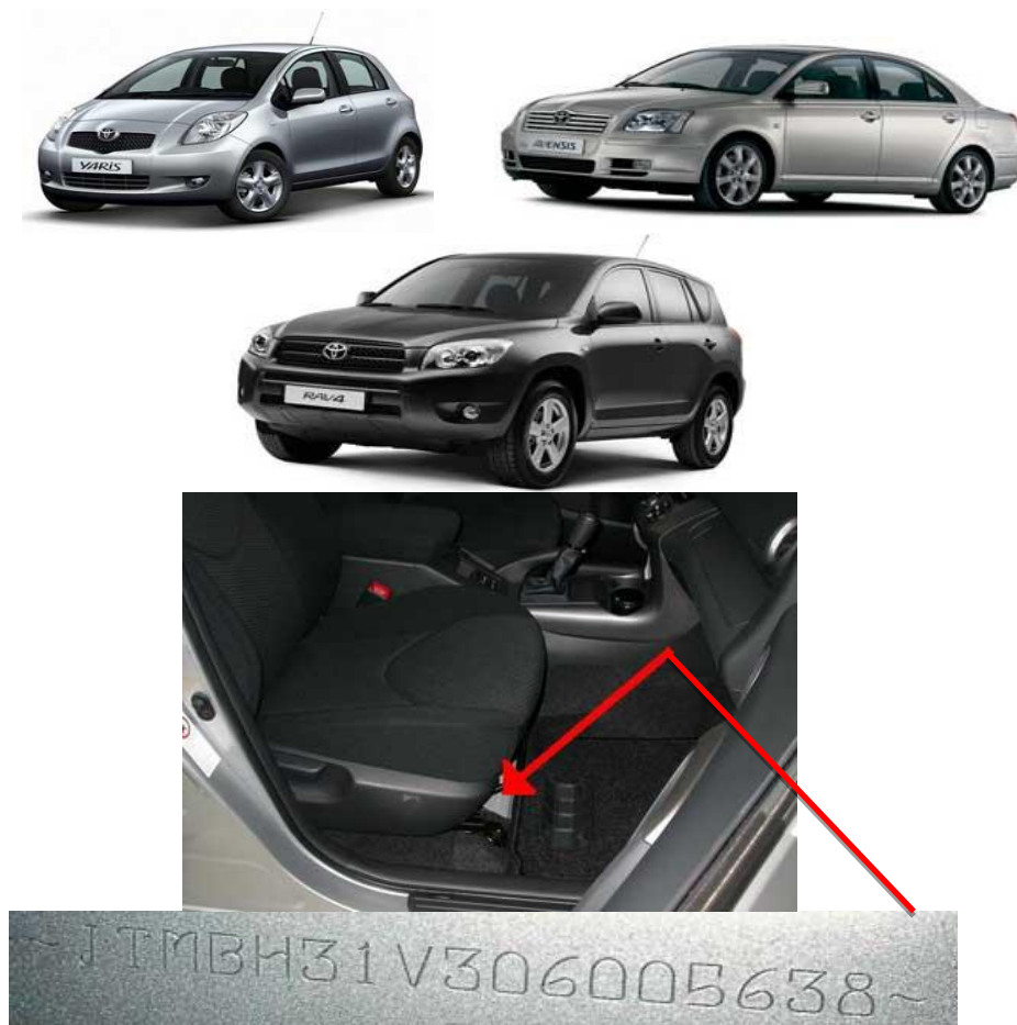
Figura 59. Identificación de chasis para vehículos tipo monocasco debajo de asiento de copiloto
