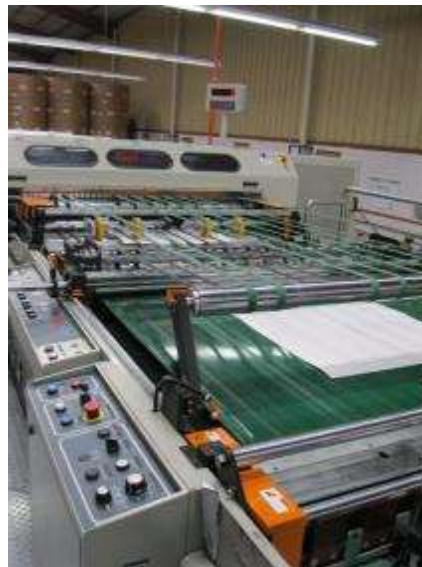
Figura 20. Cortadora 3 en paro, por accionamiento de de emergencia
