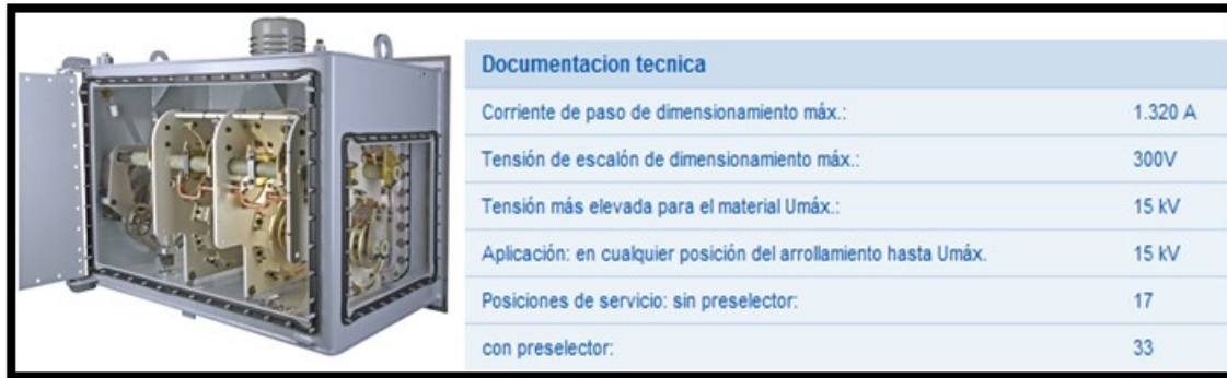
Figura 48. Cambiador de derivaciones bajo carga RMV
