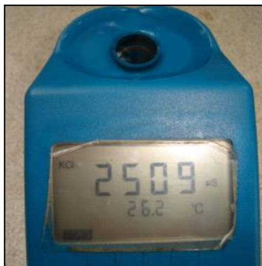
Figura 97. Obtención del resultado de conductividad
