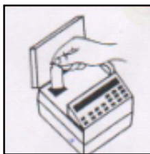
Figura 110. Colocación correcta de muestra 1 en espectrofotómetro
