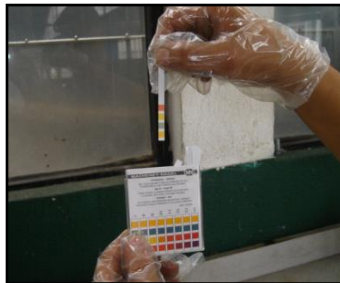
Figura 86. Forma correcta de tomar medidor de pH
