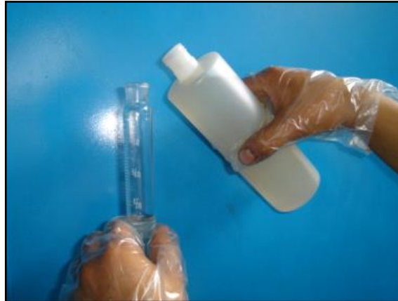
Figura 98. Vertido correcto de muestra en probeta
