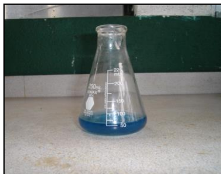
Figura 94. Color correcto de la muestra a analizar
