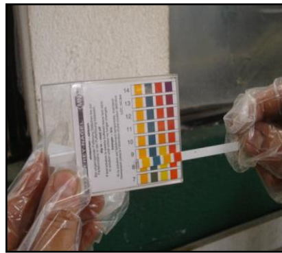
Figura 88. Obtención de resultado de pH del agua
