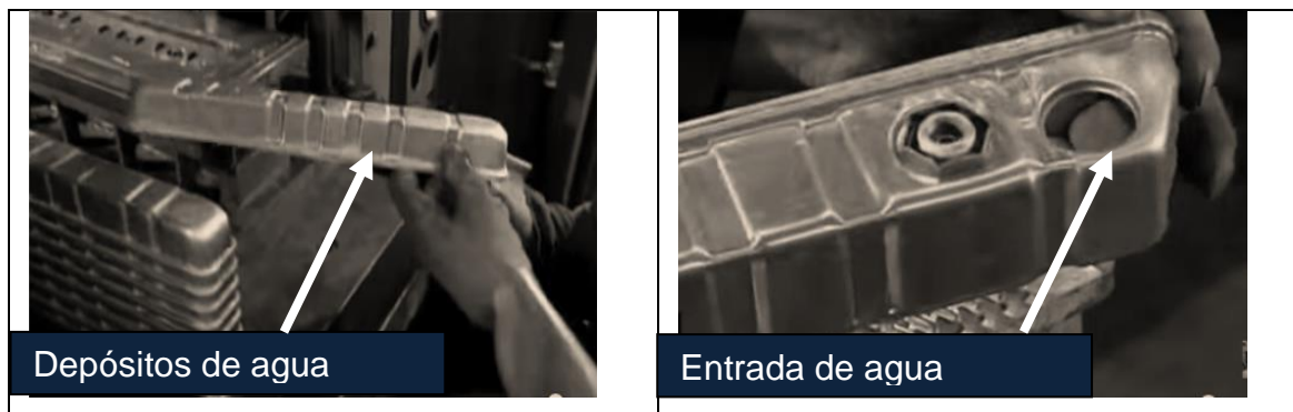
Figura 44. Depósitos de agua
