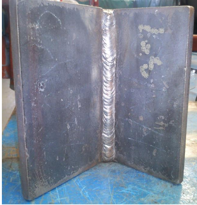
Figura 18. Soldadura en ángulo interior posición vertical ascendente
