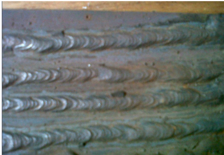
Figura 21. Depósito de cordones angostos en posición plana horizontal
