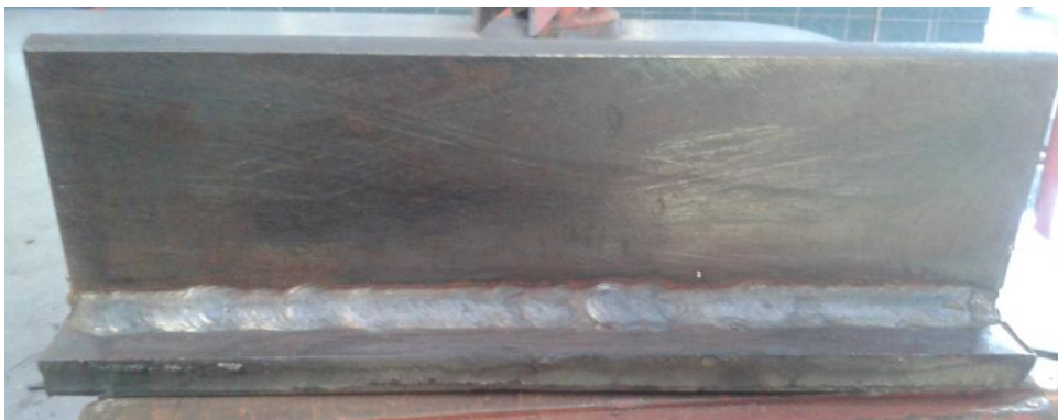
Figura 38. Soldadura en ángulo interior posición plana horizontal
