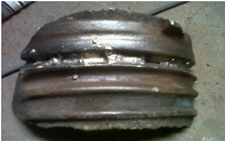
Figura 30. Soldadura a tope con bisel en V en posición plana horizontal, cordones de raíz
