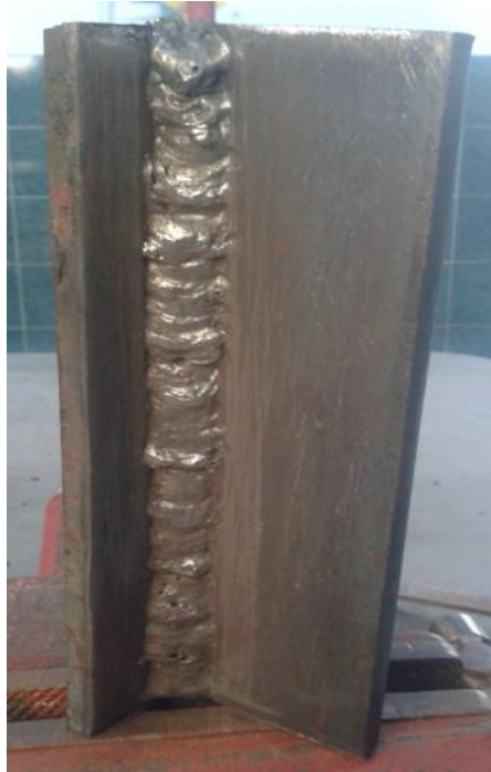
Figura 39. Soldadura en ángulo interior posición vertical ascendente
