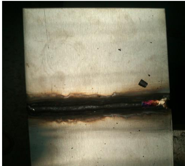
Figura 24. Soldadura a tope en I en posición plana horizontal, cordón de presentación aun con la escoria
