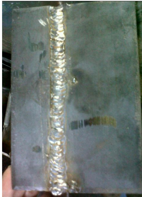
Figura 37. Soldadura a tope con bisel en V en posición vertical ascendente
