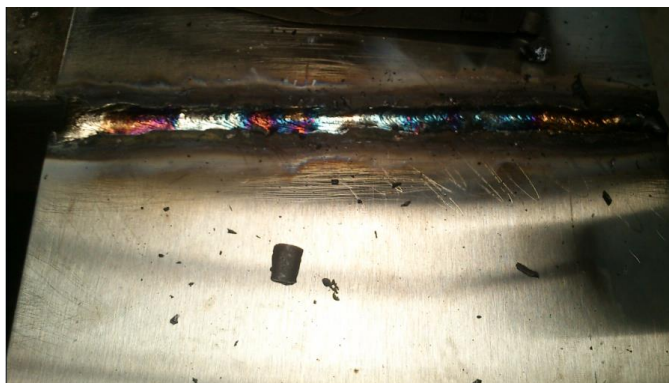
Figura 25. Soldadura a tope en I en posición plana horizontal, cordón de presentación sin cepillar
