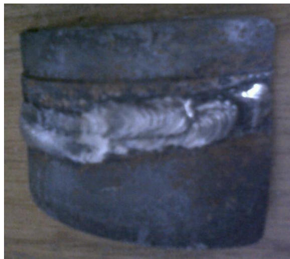
Figura 32. Soldadura a tope con bisel en V en posición plana horizontal, cordones de presentación, cilindro de camión
