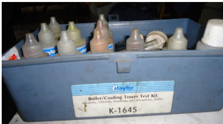
Figura 38. Equipo para medición de propiedades del agua
