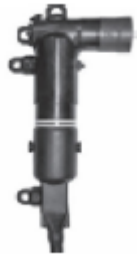
Figura 10. Codo rompecarga con fusible para cables 1/0AWG Y 4/0AWG UD para 15kV
