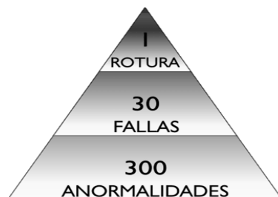
Figura 32. Proporción entre anomalía, falla y rotura
