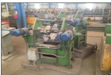
Cajas de laminación
