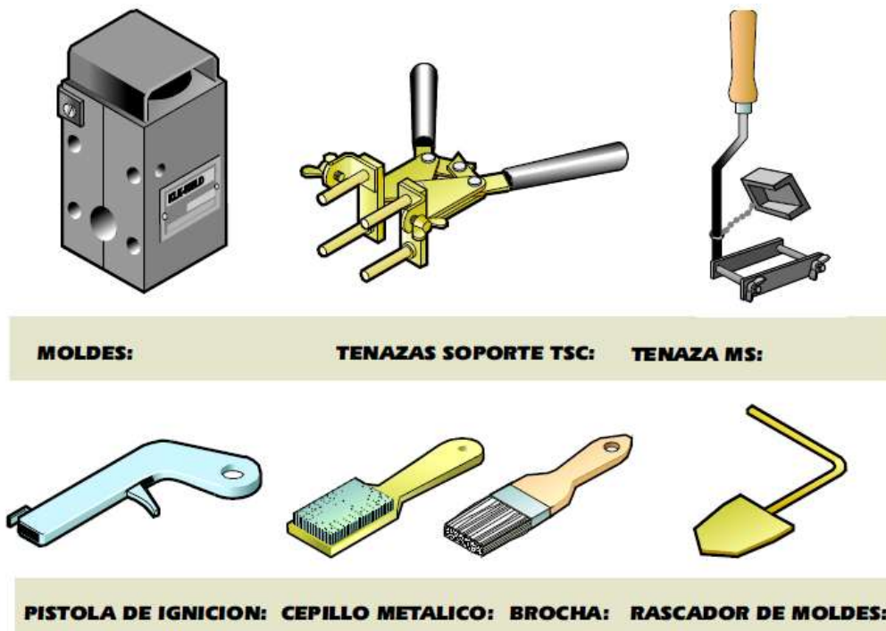
Figura 13. Equipo necesario para una soldadura exotérmica
