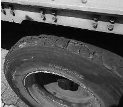
Banda de neumático con daño irregular.
