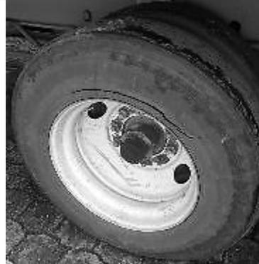
Flanco de neumático roto y neumático con poca presión.
