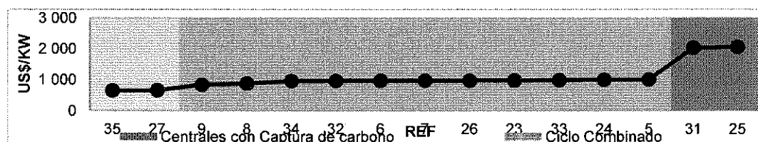
Figura 64. Clasificación de las centrales de gas natural por tipo de tecnología y costo unitario de inversión
