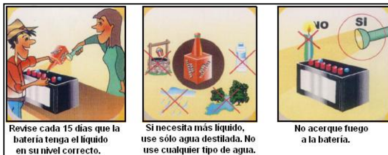
Figura 21. Mantenimiento interno solo a baterías no selladas
