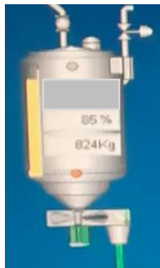
Figura 52. Forma visual de observar el porcentaje de llenado del silo
