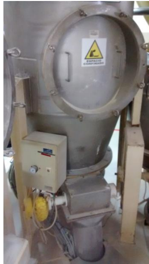
Figura 24. Parte externa del silo con su compuerta y accionador neumático
