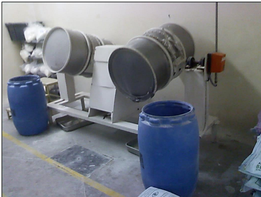
Figura 16. Mezclador de dulce en polvo
