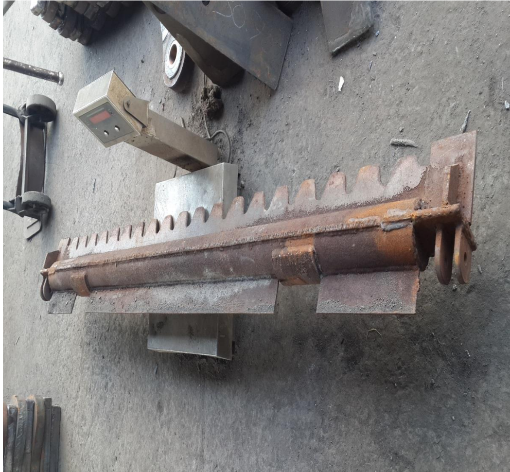
Figura 18. Tablillas utilizadas en los conductores intermedios del tándem B, en el Ingenio Magdalena
