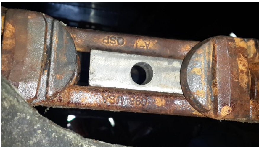
Figura 17. Cadena Rivetless 698 con barra de fijación del tándem B
