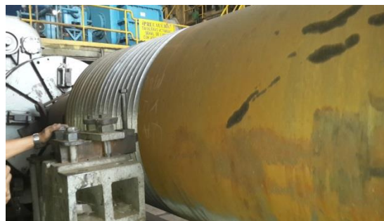
Figura 7. Maquinación del rayado del cilindro (maza)
