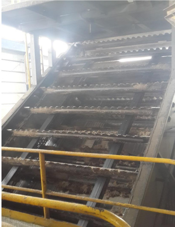
Figura 19. Conductor intermedio de cadena y tablillas del tándem B, entre los molinos 2 y 3
