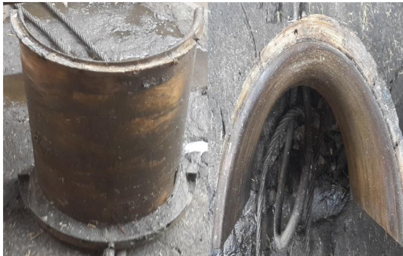
Figura 6. Chumacera desgastada y retirada
