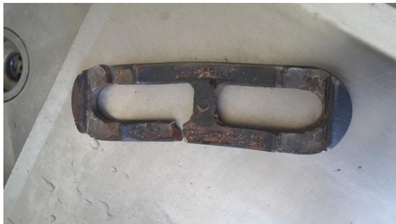
Figura 29. Falla por sobreesfuerzo en una placa del eslabón hembra
