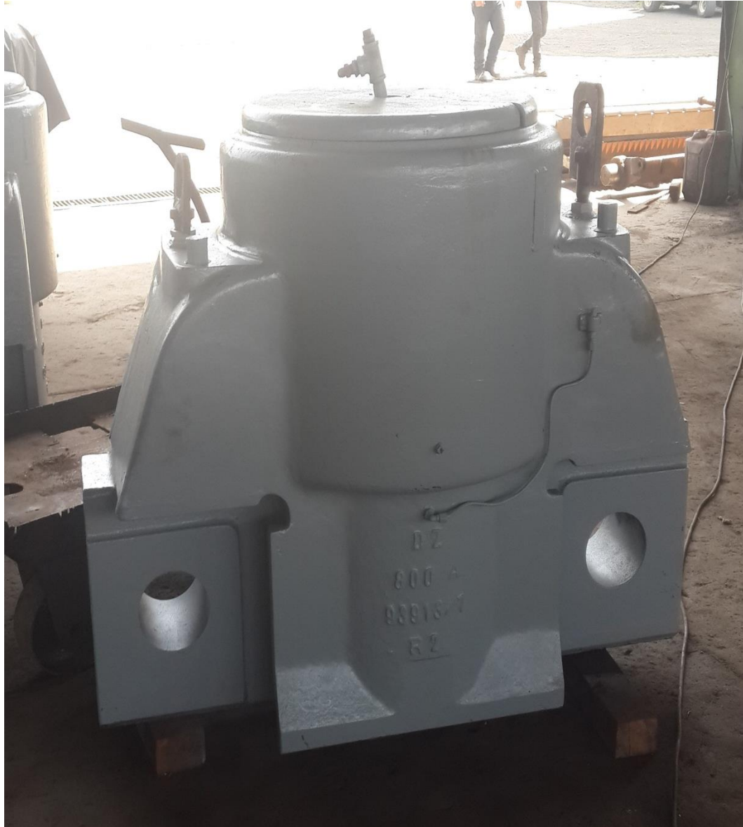
Figura 15. Cabezote hidráulico de molino 3 del tándem B después del mantenimiento y reparación
