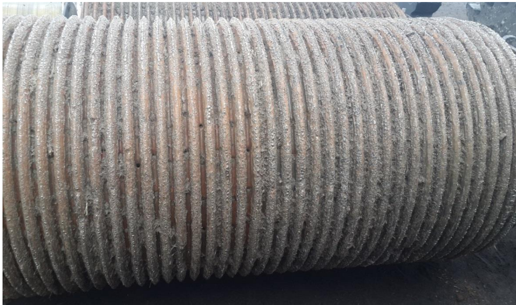
Figura 8. Maza superior perforada del tercer molino del tándem B, desmontada para reparación
