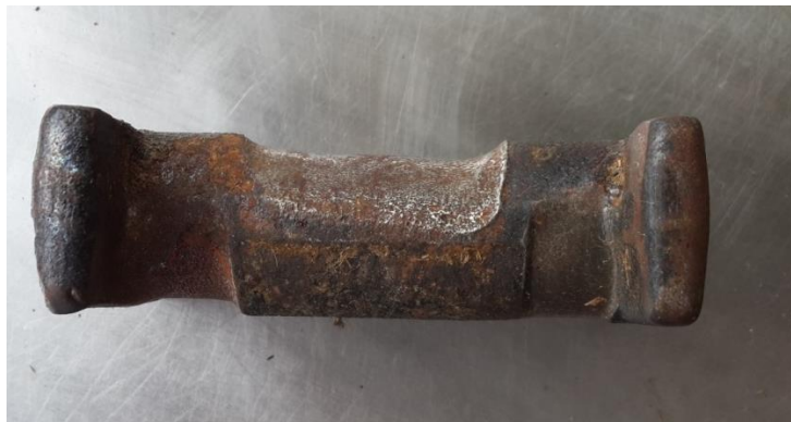
Figura 28. Desgaste del pasador de la cadena Rivetless 698
