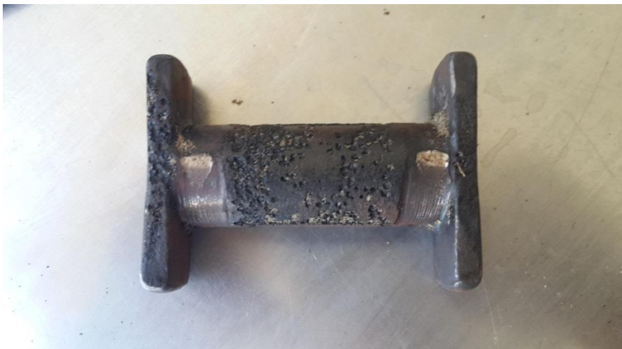
Figura 30. Pasador afectado por la abrasión
