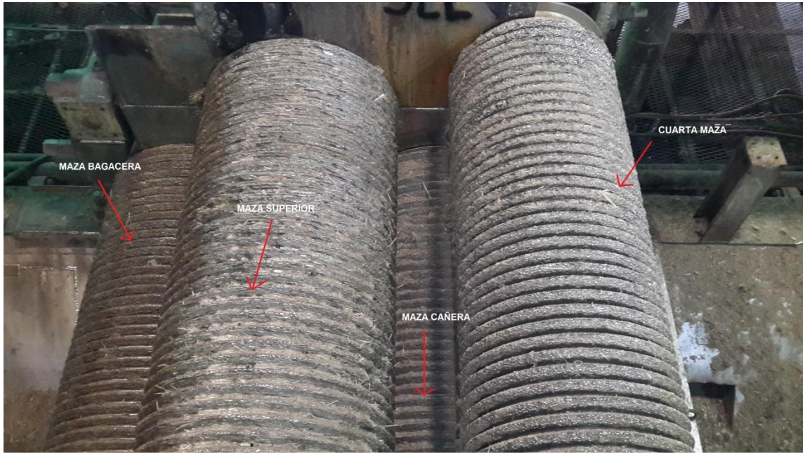
Figura 12. Posición de las mazas en los molinos
