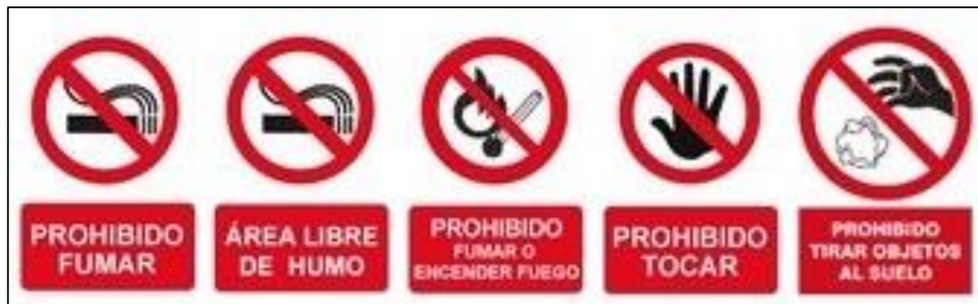
Figura 42. Señales de prohibición
