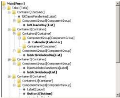
Figura 56. Árbol de componentes: muestra de manera jerárquica la estructura de los objetos pertenecientes al formulario seleccionado
