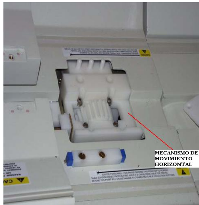
Figura 62. Mecanismo del tablero de la camilla del paciente
