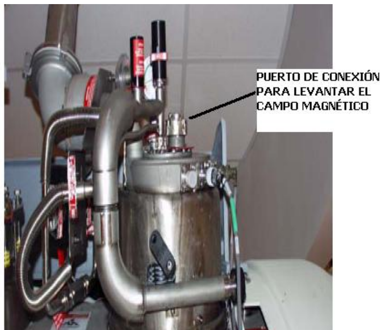
Figura 45. Torre de servicio para conexión eléctrica hacia el devanado superconductor
