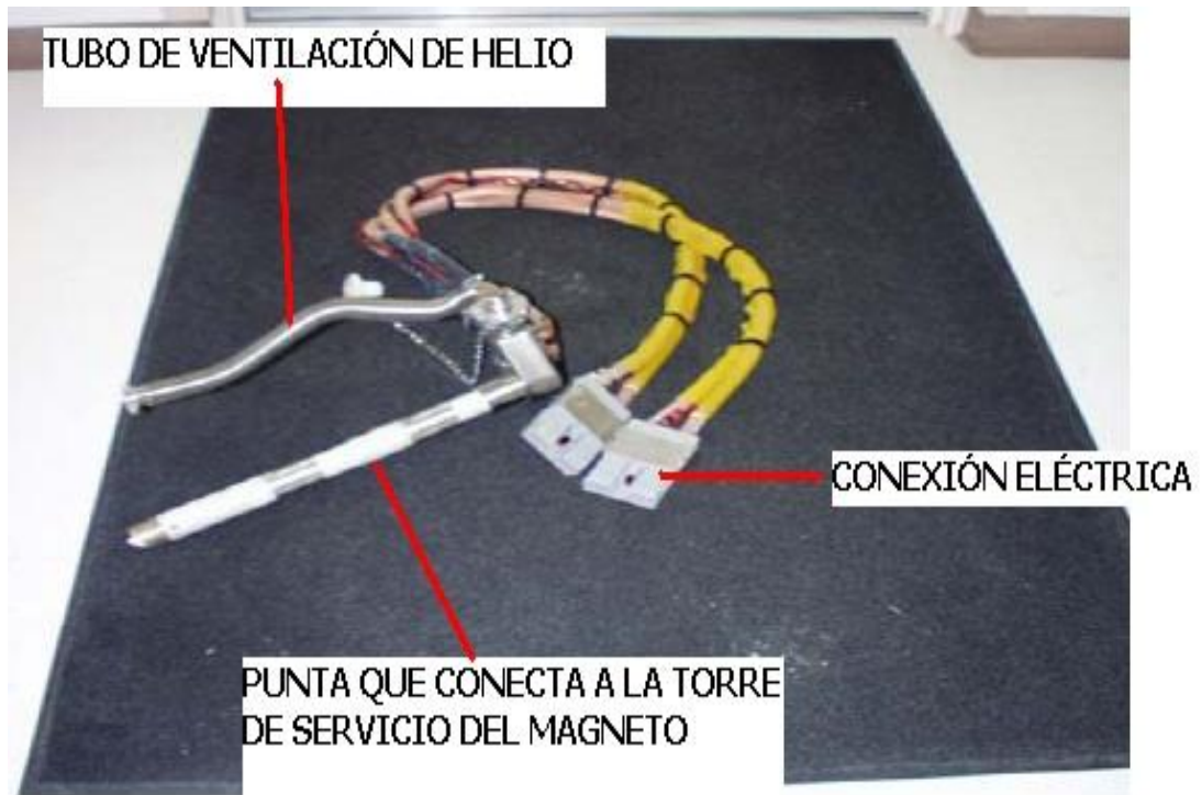
Figura 44. Punta de conexión para energizar el electroimán superconductor
