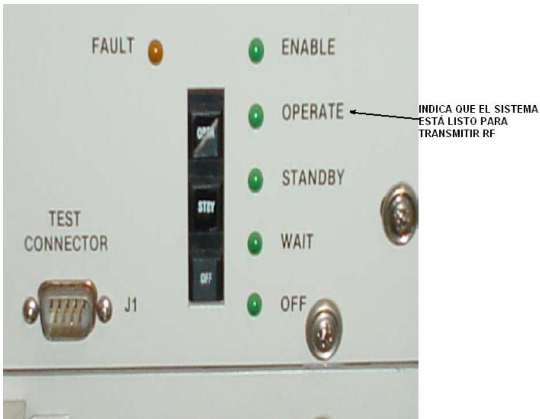
Figura 69. Leds o luces indicadoras en el panel frontal del amplificador de RF
