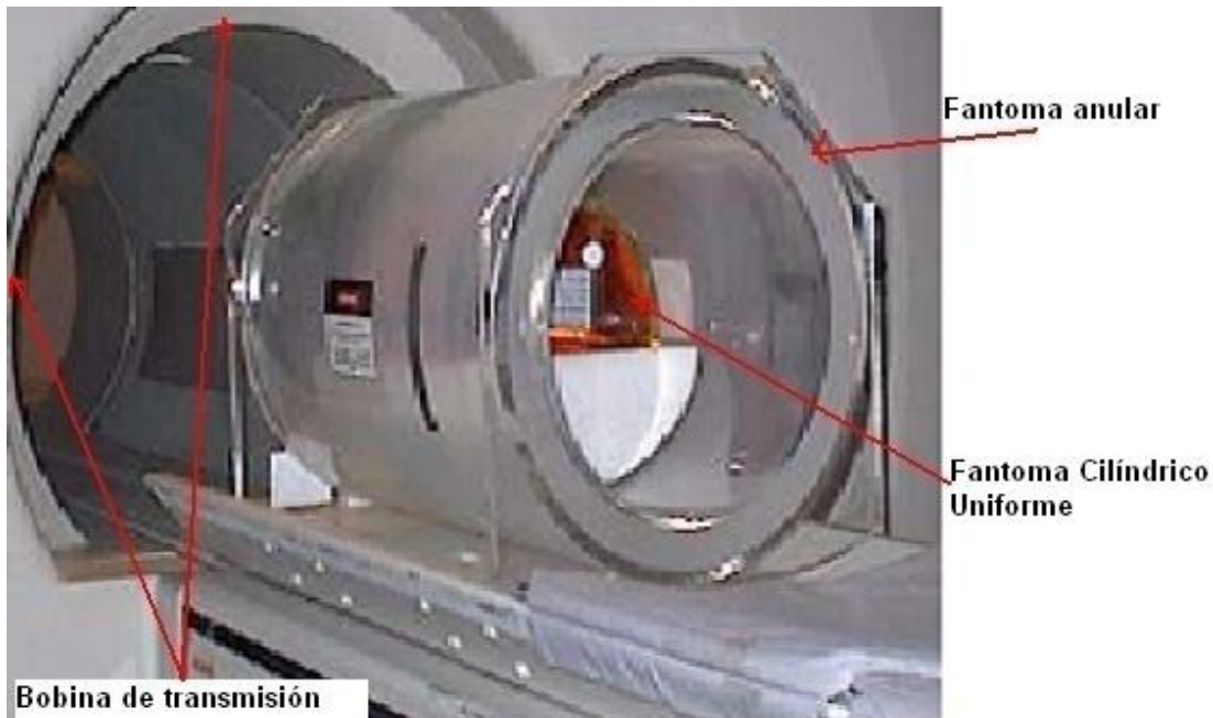
Figura 82. Posicionamiento de los fantomas para el análisis de SNR de la bobina de transmisión
