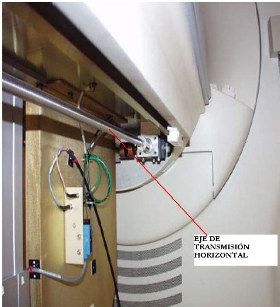
Figura 63. Parte baja interna de la camilla del paciente. Se muestra el eje de movimiento horizontal
