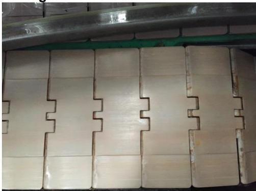
**Figura 6.** Guías en buen estado
