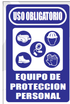
Figura 34. Rotulación de seguridad industrial-uso obligatorio de equipo de seguridad
