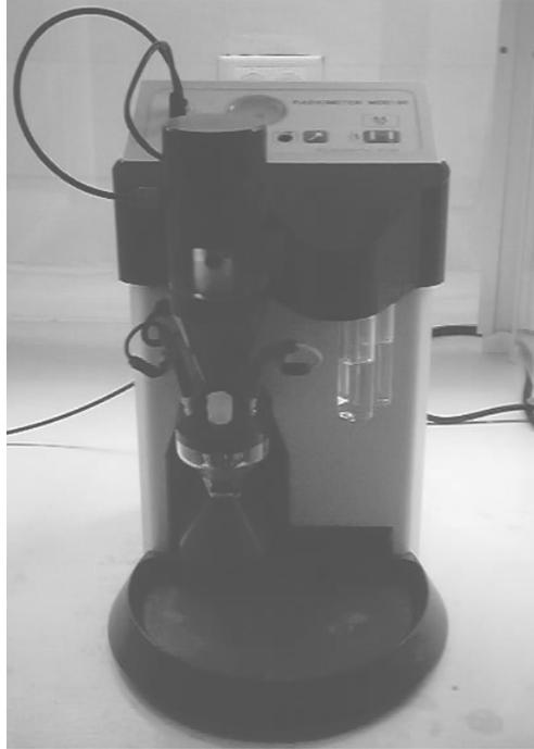
**Figura 4 Equipo Polarografo Radiometer Copenhagen POL150**
