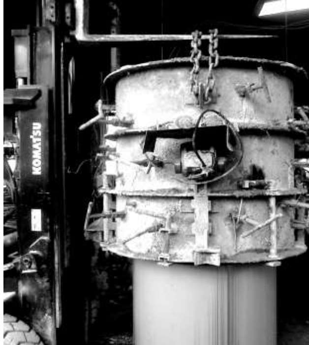
Figura 22. Desencofrado molde central
