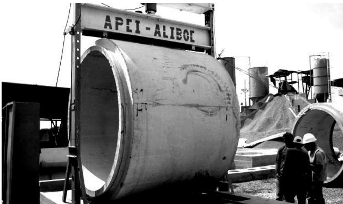
Figura 7. Máquina de ensayo método de los tres apoyos
