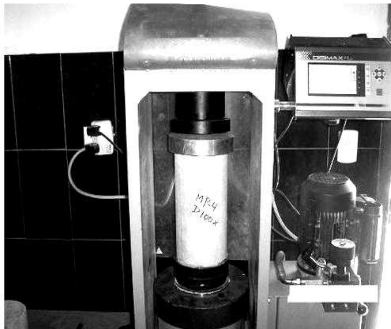
Figura 6. Probeta de concreto para ensayo de compresión
