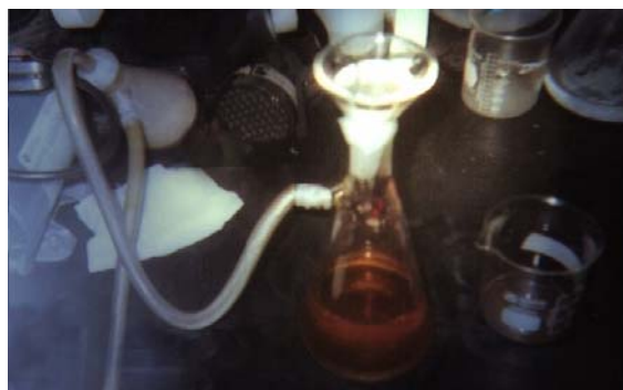
Figura 22. Filtración de la plata metálica
