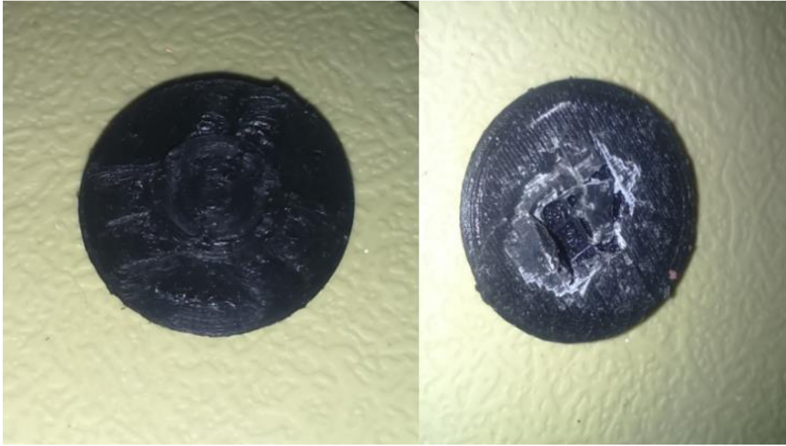
Figura 34. Fallo en impresión 3D por mal diseño
