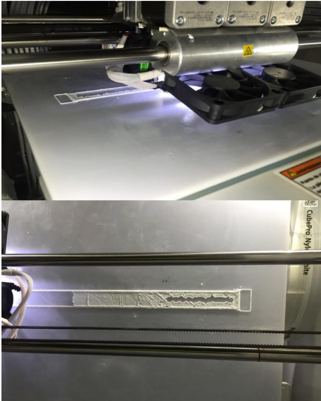
Figura 47. Impresión de base para sujetar pulsera en 3D
