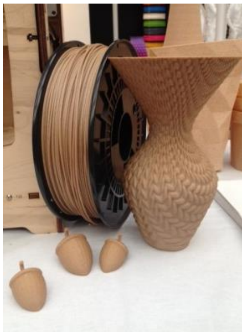
Figura 16. Pieza fabricada en 3D con filamentos de madera
