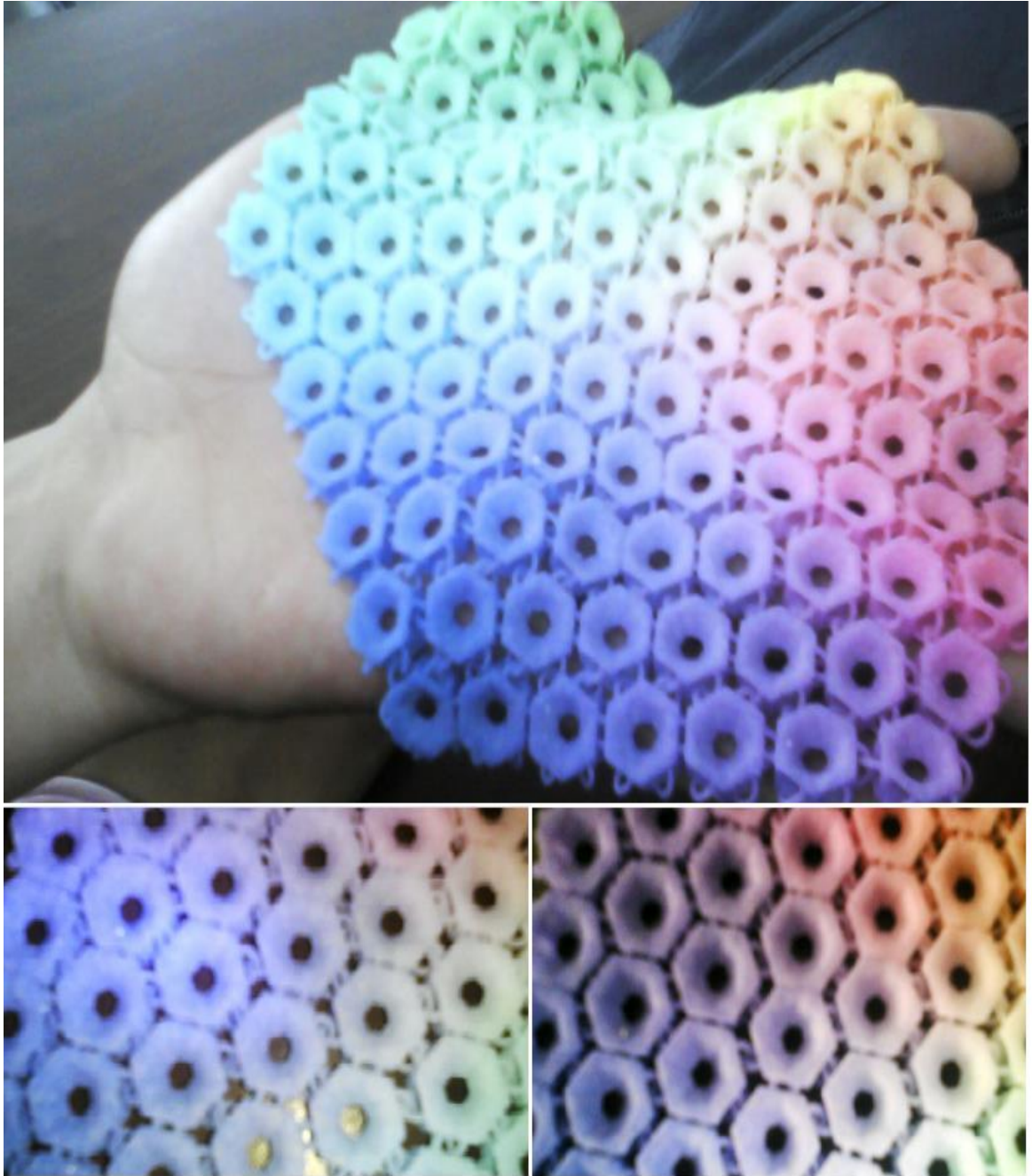
Figura 19. Malla fabricada y ensamblada simultáneamente por impresora 3D
