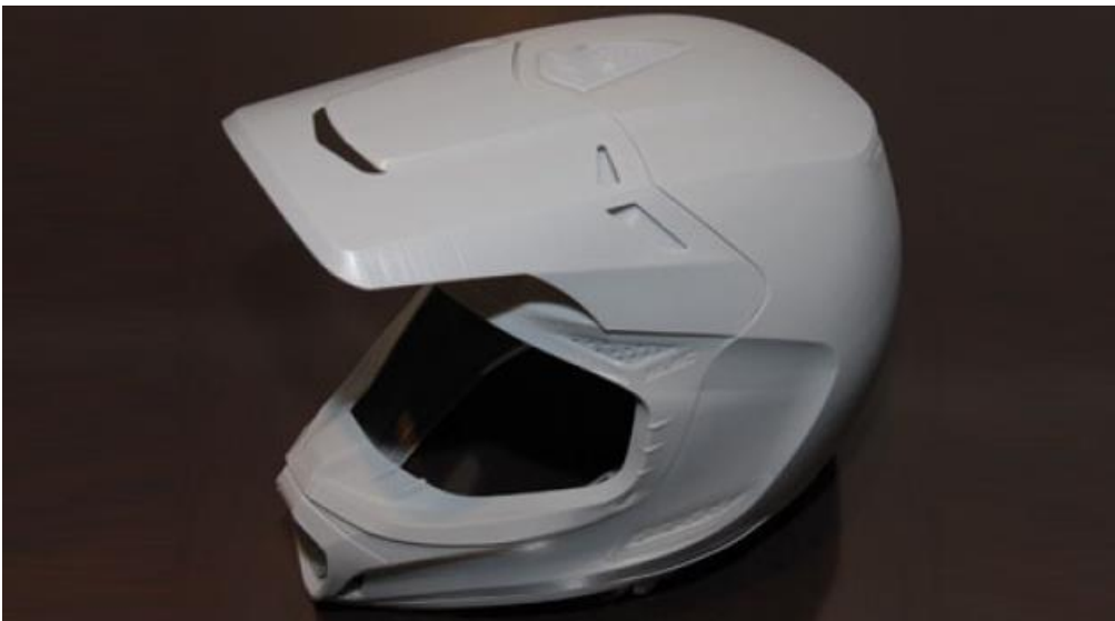
Figura 14. Piezas fabricadas tridimensionalmente a partir de polipropileno (PP) o ABS
