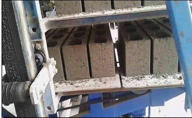
Figura 25. Sistema de elevación
