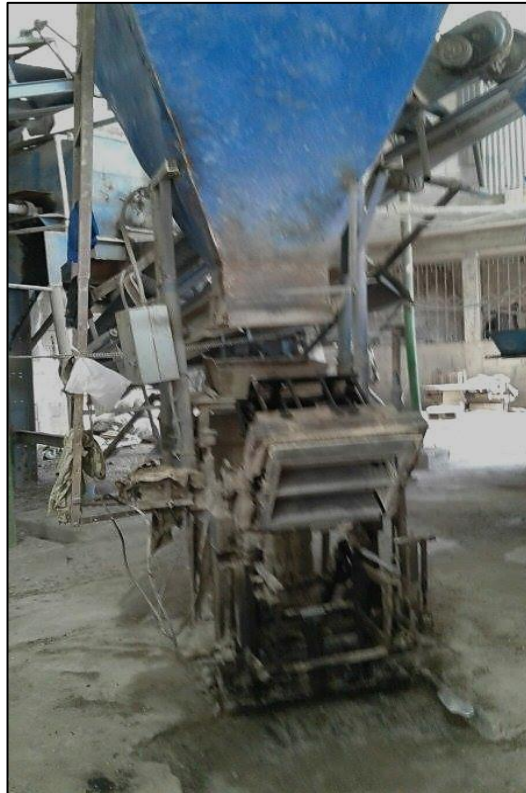
Figura 3. Maquinaria semiautomática para fabricación de blocks y banda transportadora de alimentación
