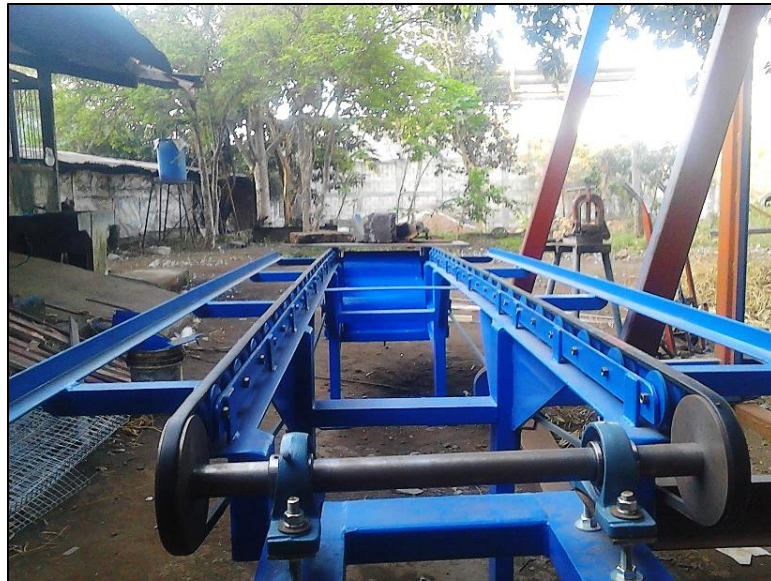
Figura 20. Banda transportadora de salida de producto terminado
