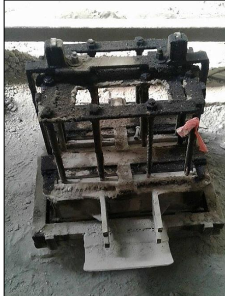
Figura 11. Sistema de vibración y molde de maquinaria semiautomática
