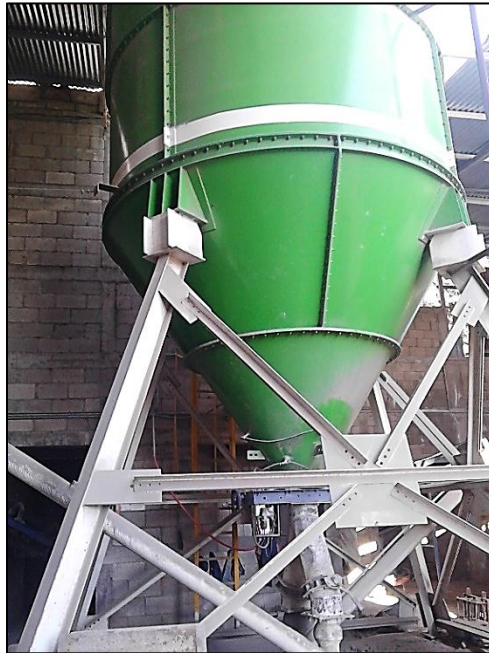
Figura 2. Silo para almacenamiento de cemento
