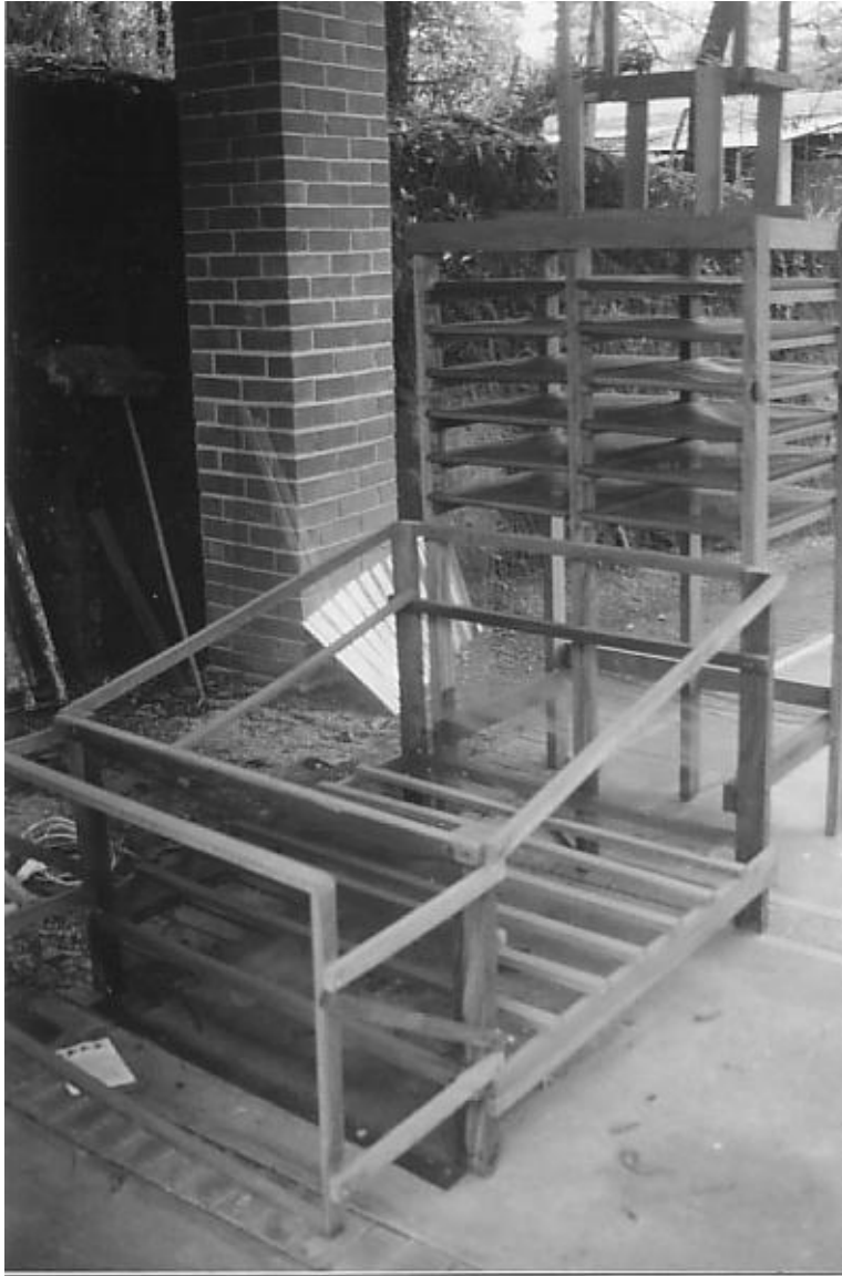
Figura 13. Colector solar y cámara de secado. Armazón de madera.
