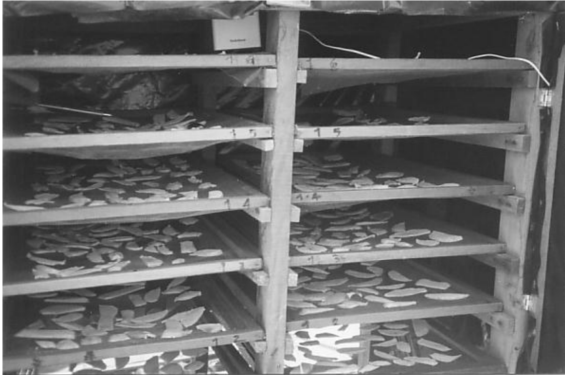
Figura 15. Bandejas con producto (rodajas de mango), colocadas dentro de la cámara de secado.
