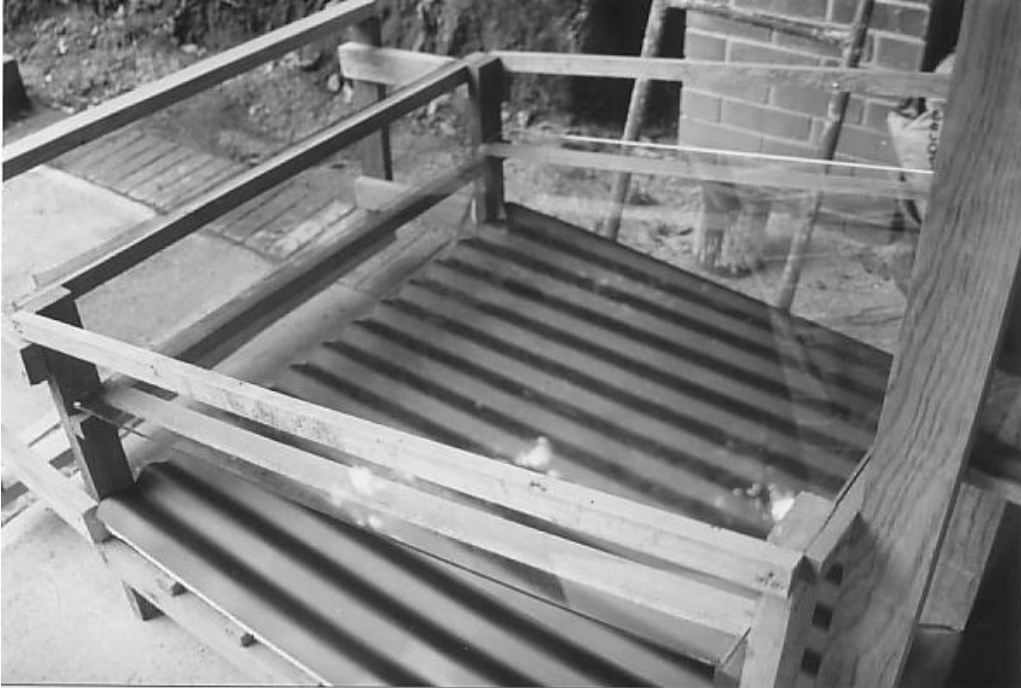
Figura 12. Colector solar, cubierta plástica transparente.
