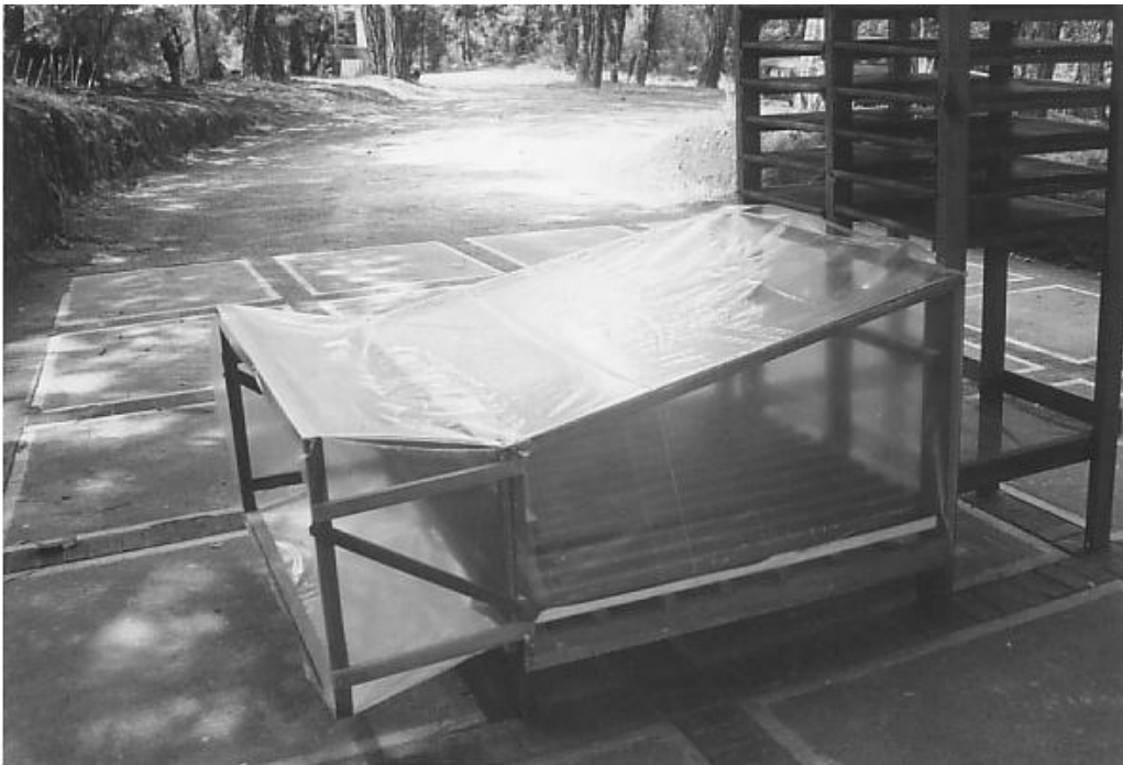
Figura 12. Colector solar, cubierta plástica transparente.
