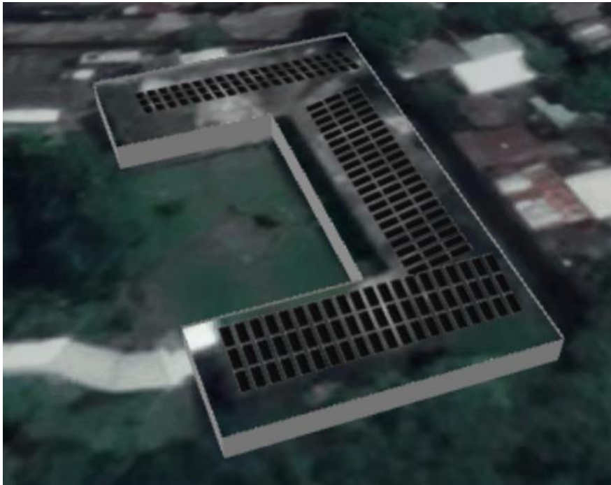
Figura 10. Ubicación de paneles solares en techo de aulas puras
