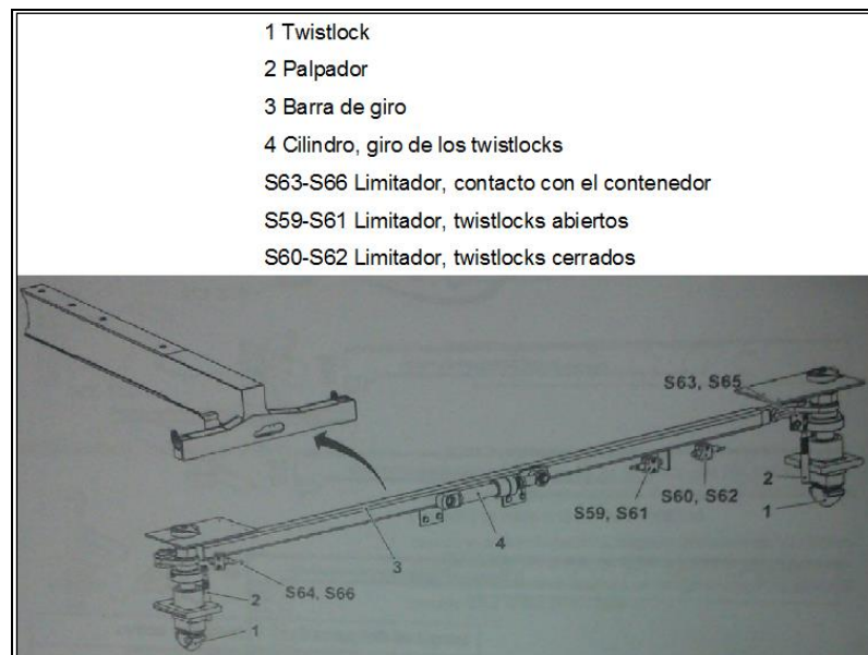
Figura 182. Viga en forma de T
