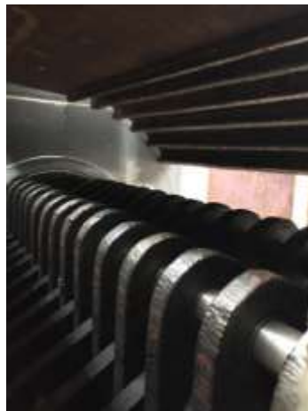
Figura 16. Relación entre el yunque y la desfibradora
