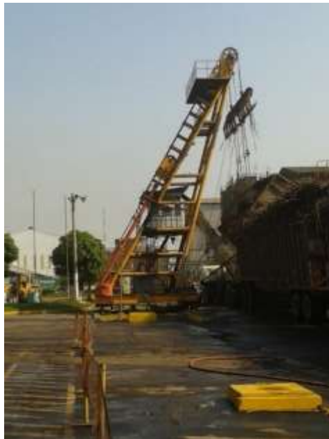
Figura 9. Malacate o virador de jaulas cañeras
