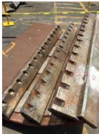
Figura 63. Yunque de la desfibradora
