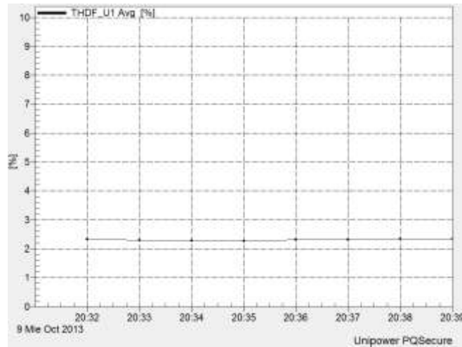
Figura 48. THDv (%) de la lámpara conectada a una fuente de 208 VAC
