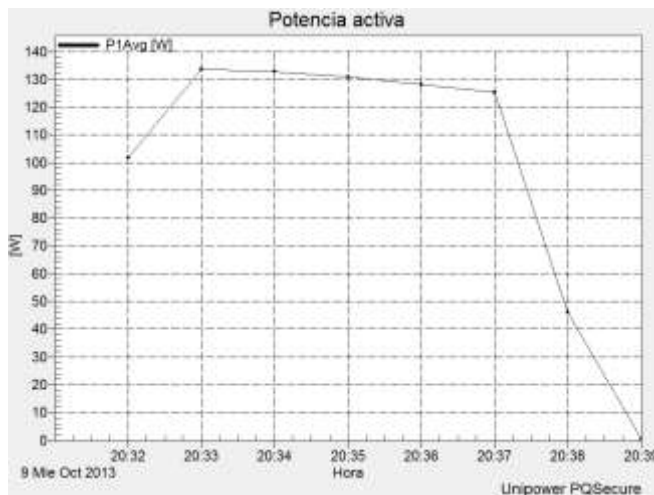
Figura 43. Variación de la potencia activa respecto del tiempo de la lámpara conectada a una fuente de 208 VAC
