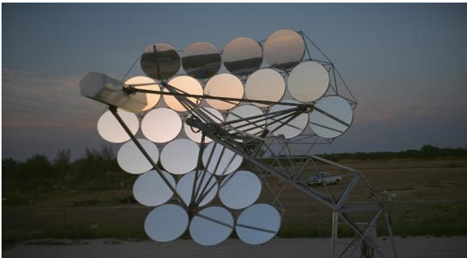
Figura 29. Sistema disco Stirling compuesto por segmentos
