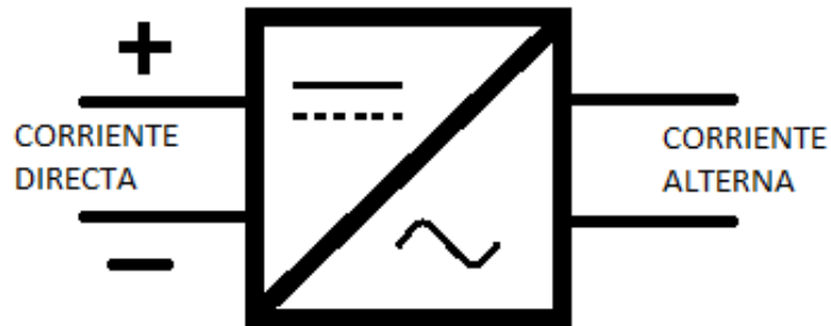
Figura 6. Inversor de corriente directa a corriente alterna
