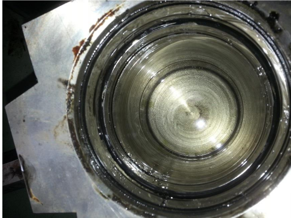
Figura 43. Motor hidráulico, parte interna
