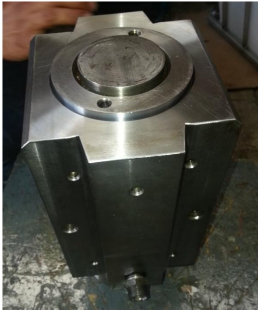
Figura 46. Motor hidráulico armado
