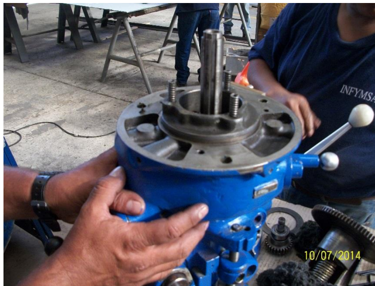
Figura 20. Sistema de conexión del husillo
