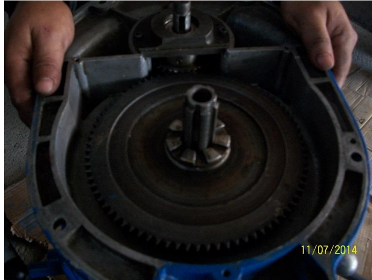
Figura 33. Sistema de conexión entre pluma y poleas
