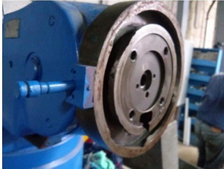
Figura 28. Adaptador en mal estado
