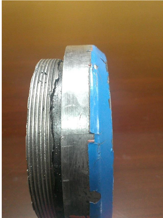
Figura 26. Tapa contra la suciedad del husillo dañada
