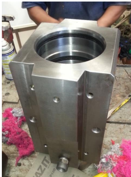
Figura 45. Motor hidráulico con o-rings nuevos
