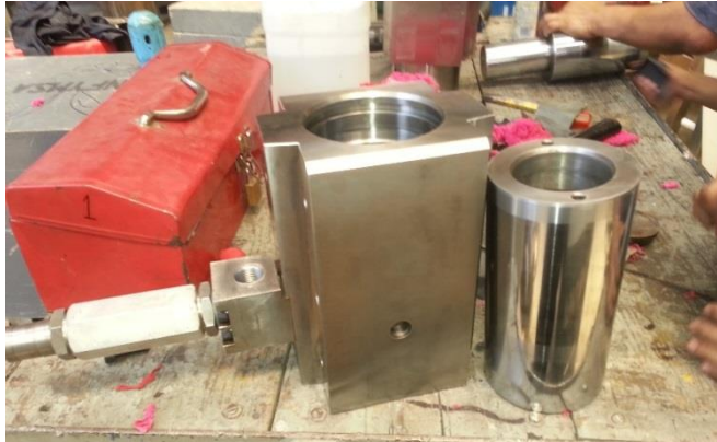
Figura 44. Motor hidráulico después de la limpieza
