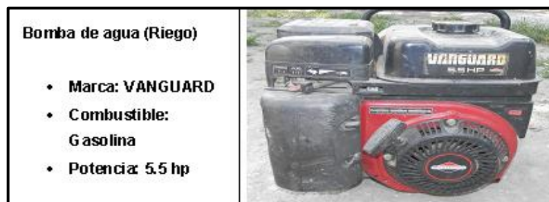
Figura 7. Bomba de agua para riego
