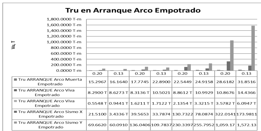
Figura 113. Representación de magnitudes graficas de fuerzas de torsión Trx para arcos empotrados
