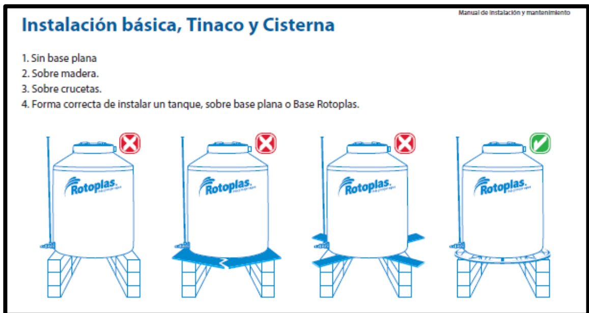
Figura 25. Instalación del tanque principal
