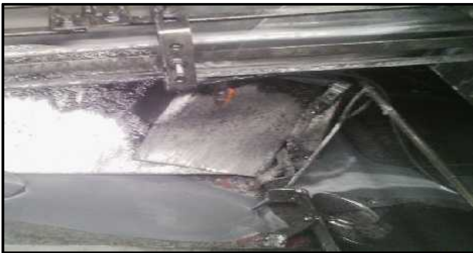
Figura 45. Fugas por bandejas de recolección rotas
