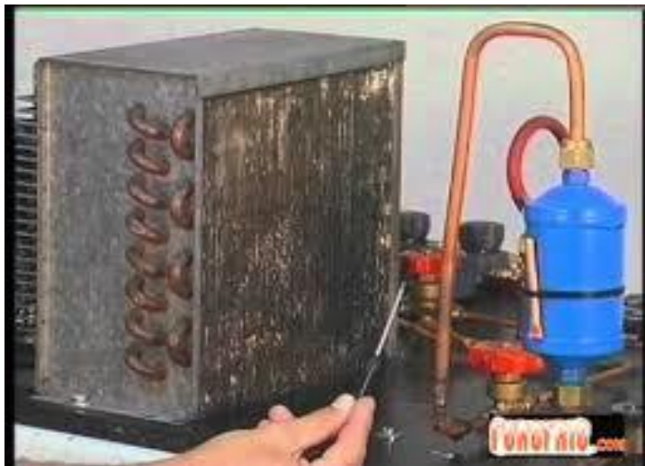
Figura 12. Tubo capilar y filtro deshidratante instalados conjuntamente
