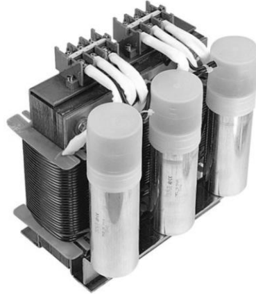
Figura 8. Filtro LC utilizado como elemento de choque
