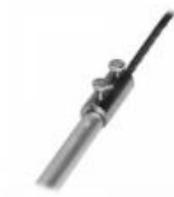
Introducir en el manguito de conexión los extremos de los cables a unir procurando que ambos cables entren la misma longitud. Evitar que los cables queden flojos o muy tensos.
