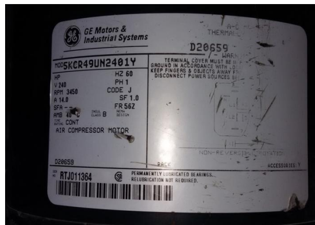
Figura 6. Placa técnica del motor del compresor
