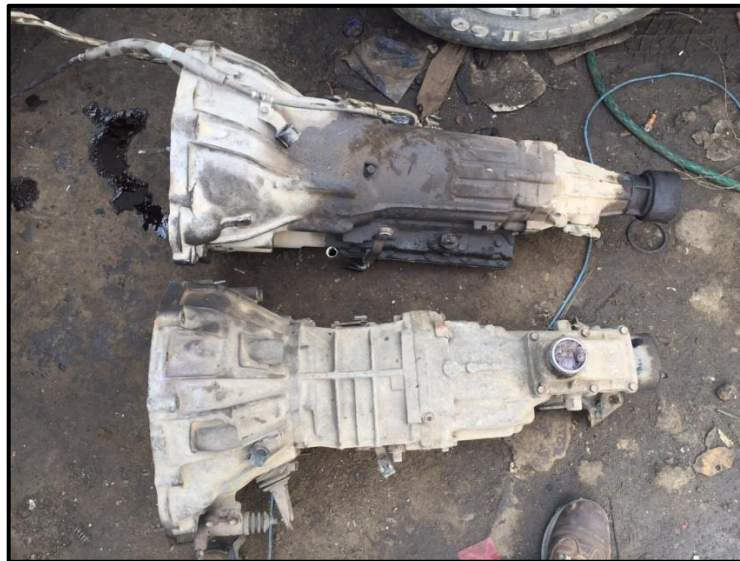
Figura 30. Vista de caja hidráulica y caja mecánica
