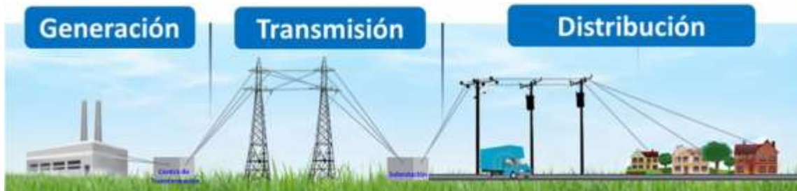
Figura 2. Sistema Eléctrico de Potencia
