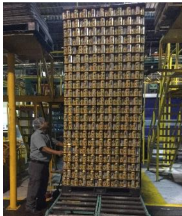
Figura 5. Operador alineando pallet en carrilera
