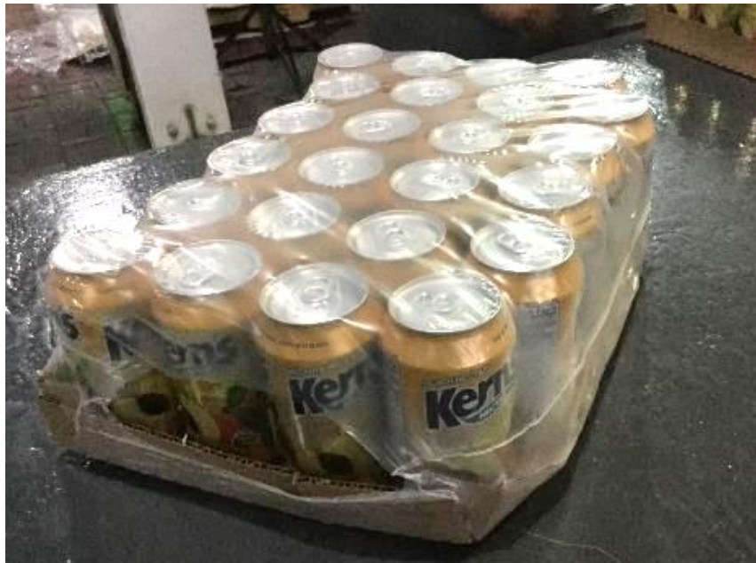
Figura 31. Bandeja sin tensión por termoencogible de menor calibre
