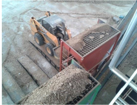
Figura 8. Proceso de mezcla y alimentación de combustible
