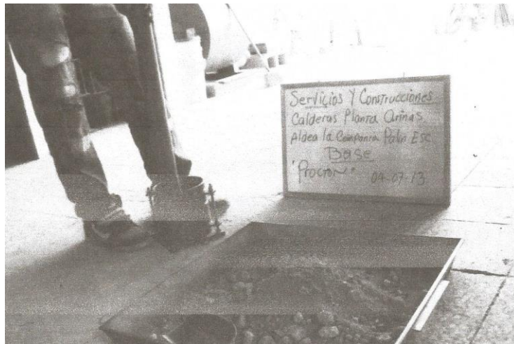
Figura 13. Pruebas y ensayos Procton de la muestra
