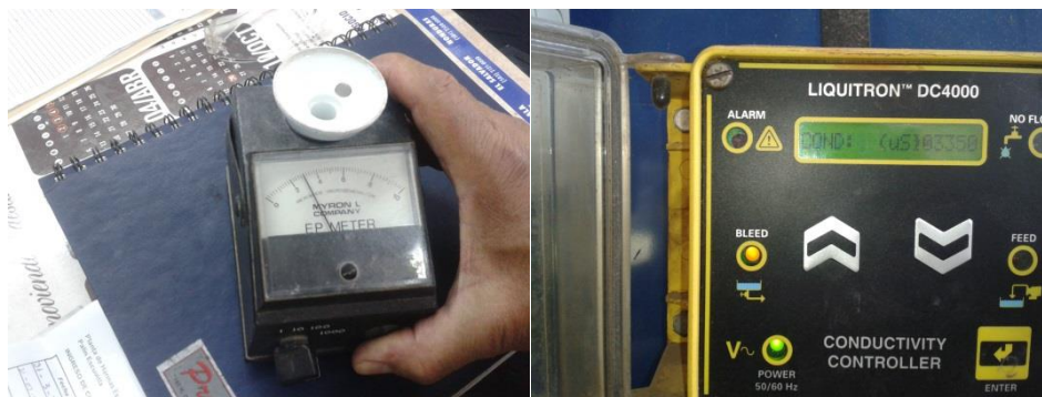
Figura 27. Comparación análoga y digital del análisis de conductividad
