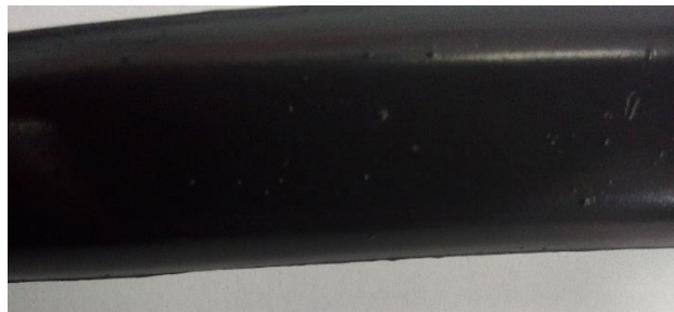
Figura 3. Partículas de polvo en material inyectado
