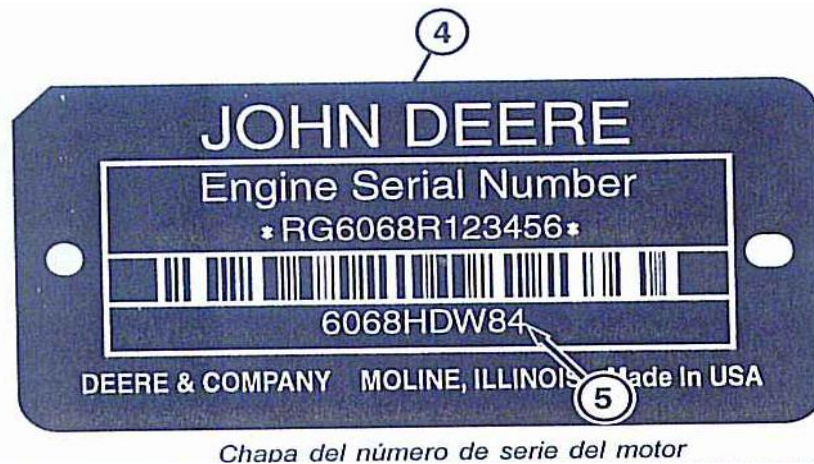
Figura 3. Plaqueta de identificación número de motor
