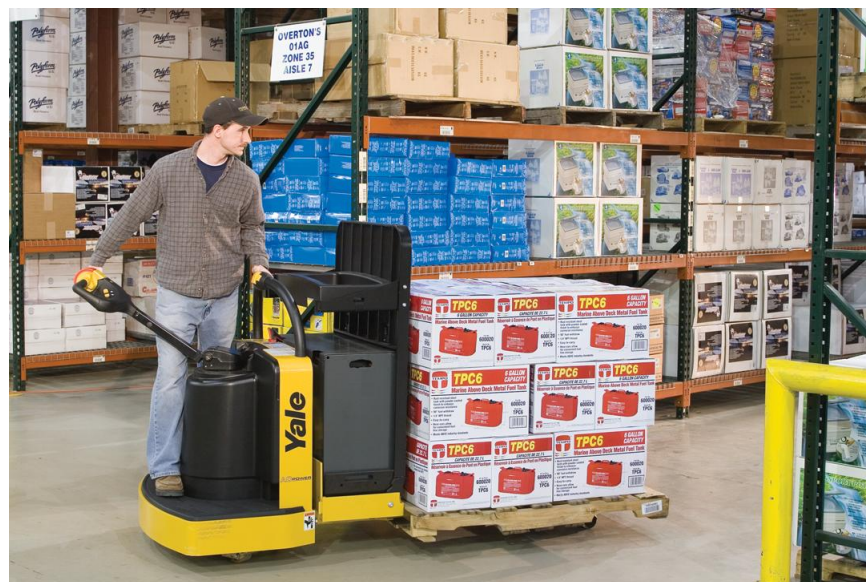
Figura 10. Montacargas eléctrico pasajero en plataforma
