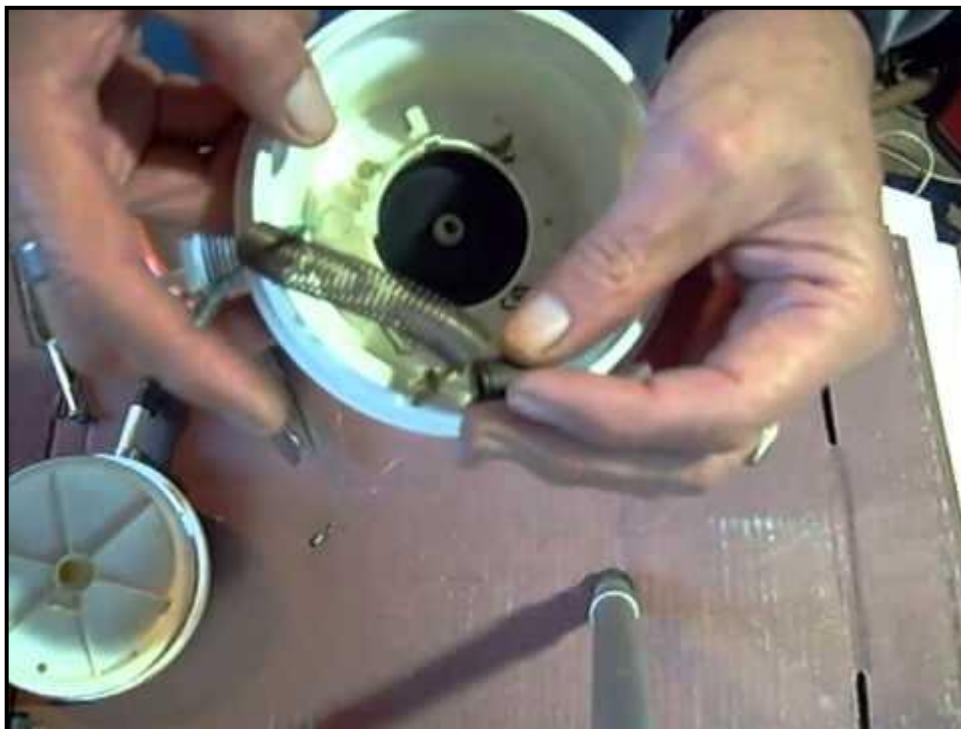
Figura 11. Vista de resistencia eléctrica dañada
